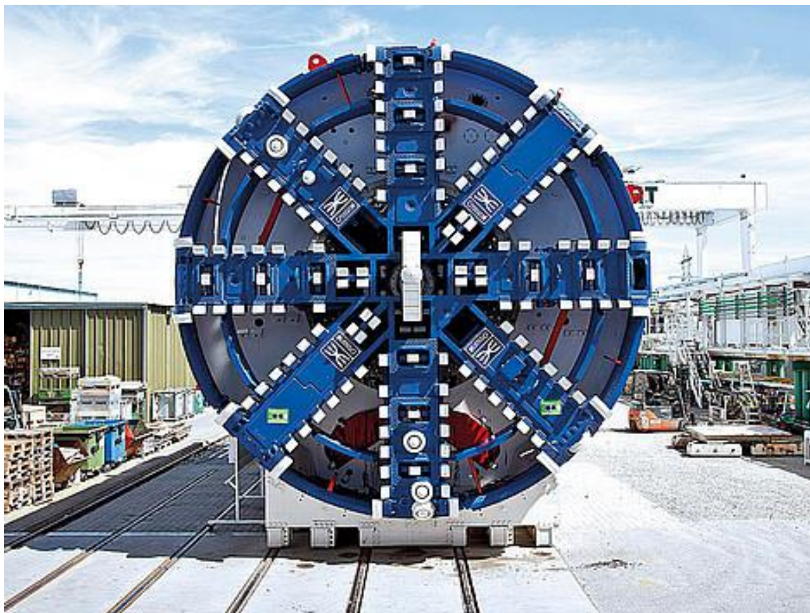
Εικόνα 1-18: Κοπτική κεφαλή του μηχανήματος Mixshield που χρησιμοποιήθηκε στο Μετρό του Λονδίνου (πηγή: SOA of Mechanized Shield Tunneling) [15]
