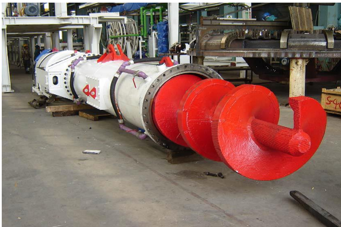
Εικόνα 1-8: Απεικόνιση ατέρμονα κοχλία με κεντρικό άξονα περιστροφής (πηγή: SOA of Mechanized Shield Tunneling) [15]
