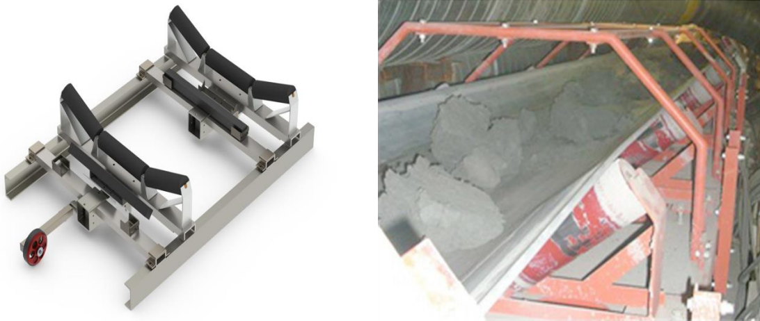
Εικόνα 2-1: Μοναδιαίος μετρητής βάρους και μηχανικός ιμάντας μέτρησης εδαφικού όγκου όπως είναι τοποθετημένα στο εσωτερικό ενός μηχανήματος TBM (πηγή: TBM Conveyor belt scales, the university link project experience, Indra Banerjee CH2M HILL, Inc. Richard McLane Traylor Bros., Inc. Ed Shorey CH2M HILL, Inc., Paul Gasson CH2M HILL, Inc.)
