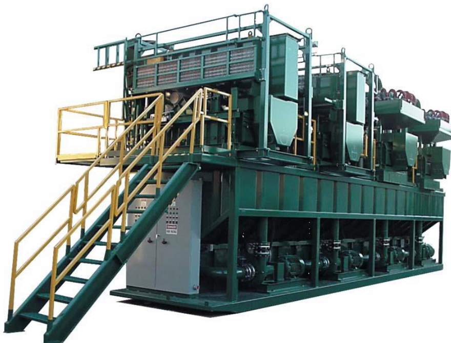
Εικόνα 1-21: Σύστημα διαχωρισμού εδαφικού υλικού από το μπετονιτικό αιώρημα κατά Derrick TBSS-450 (πηγή: SOA of Mechanized Shield Tunneling) [15]
