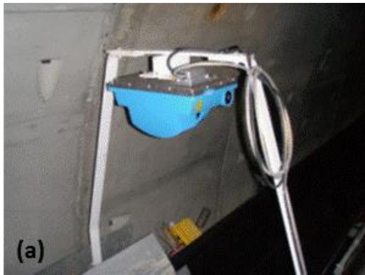
Εικόνα 2-2: Μετρητής scanner για τον προσδιορισμό του εδαφικού όγκου – Courtesy of SICK AG (πηγή: SOA of Mechanized Shield Tunneling) [15]
