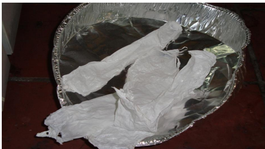
Σχήμα 5.3: Η αρχική μορφή των φιλμ που παρασκευάζονται με την τεχνική του διαλύματος.
