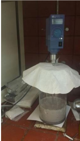
Εικόνα Π.1: Διάλυση πολυμερούς με διαλύτη MEK.
