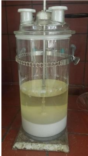
Εικόνα Π.2: Καταβύθιση πολυμερούς με αντιδιαλύτη προπανόλη.
