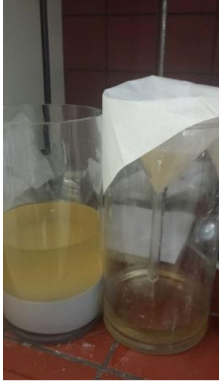
Εικόνα Π.4: Διήθηση πολυμερούς σε διηθητικό χαρτί.
