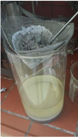
Εικόνα Π.3: Διήθηση πολυμερούς-φιλτράρισμα.
