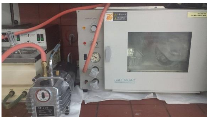
Εικόνα II.5: Ξήρανση ανακτημένου PVC και αδιάλυτων στερεών.
