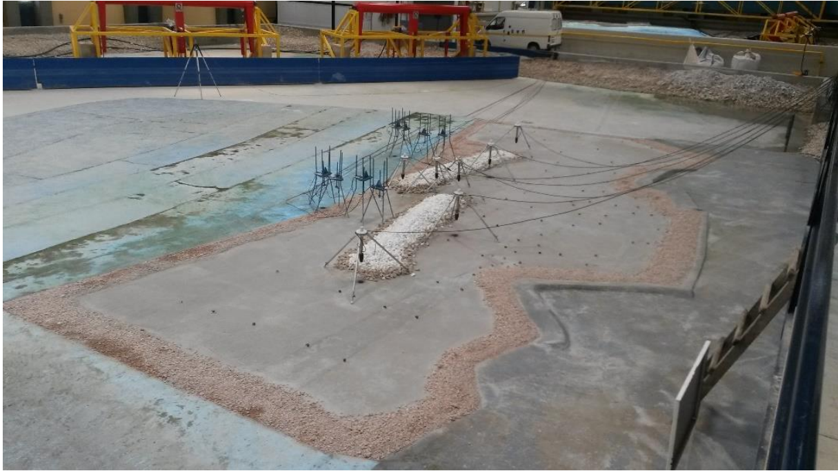
Εικόνα 4.1. Το φυσικό προσομοίωμα πριν την προσθήκη νερού στη δεξαμενή
