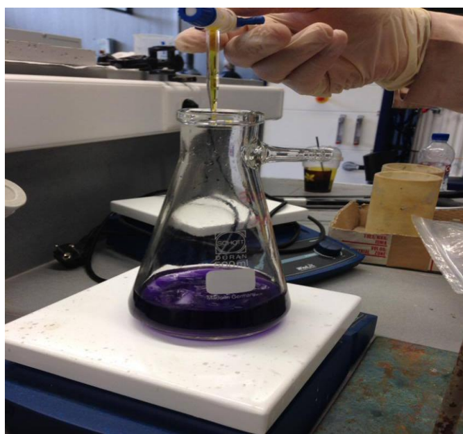
Εικόνα 18. Προσδιορισμός \text{Fe}^{2+} στο δείγμα λατερίτη με τιτλοδότηση \text{K}_2\text{Cr}_2\text{O}_7
