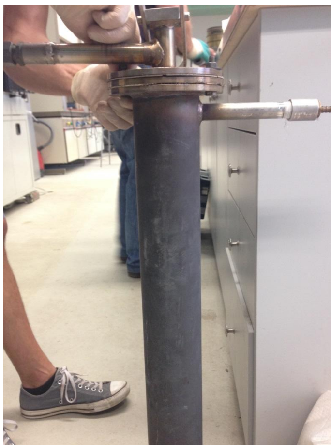
Εικόνα 34. Συναρμολόγηση συστήματος του κυλίνδρου αναγωγής, αμέσως μετά τη φόρτωση των προς αναγωγή σφαιριδίων
