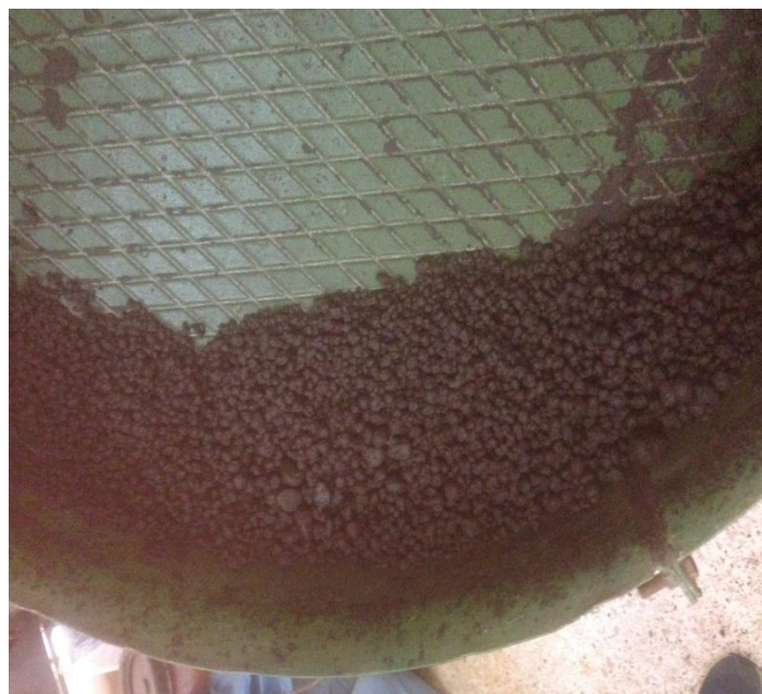
Εικόνα 20. Παραγωγή σφαιριδίων σε περιστρεφόμενο δίσκο
