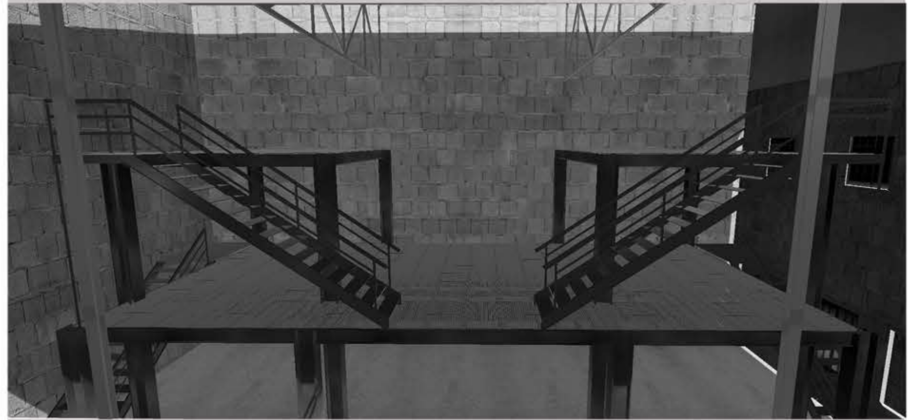
Προσθήκη χυτού δαπέδου με αρμούς που θα δεχθούν συρόμενα πάνελ και μεταλλικού παταριού για την εξέλιξη του παιχνιδιού σε δεύτερη και τρίτη στάθμη.
