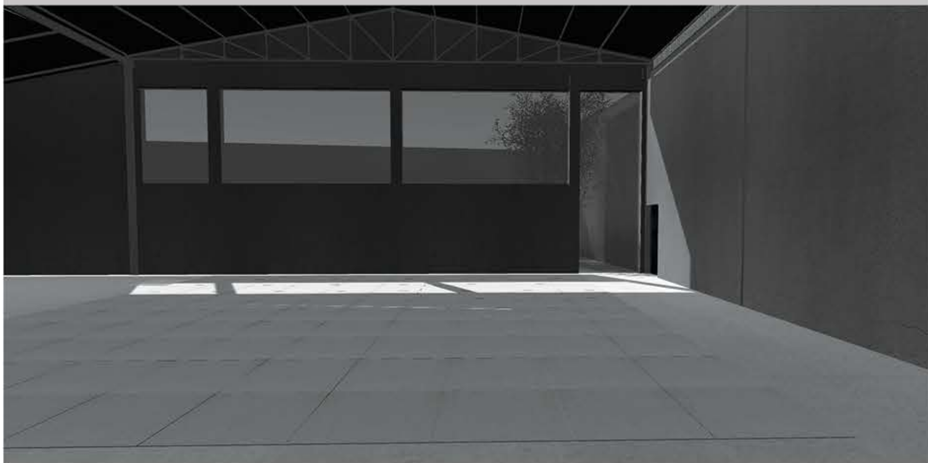
Προσθήκη τοίχου ώστε να κλείσει το κέλυφος. Προσθήκη χυτού δαπέδου με αρμούς που θα δεχθούν συρόμενα πάνελ.
