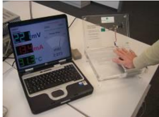
Εικόνα 2.13 Η θερμοηλεκτρική γεννήτρια του Fraunhofer η οποία διαθέτει ένα κύκλωμα το οποίο εκκινεί με χαμηλή τάση
