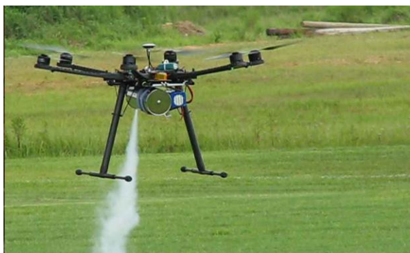
Εικόνα 1.6: Drone για αγροτικό ψεκασμό ακριβείας – Πηγή: Associated Press
