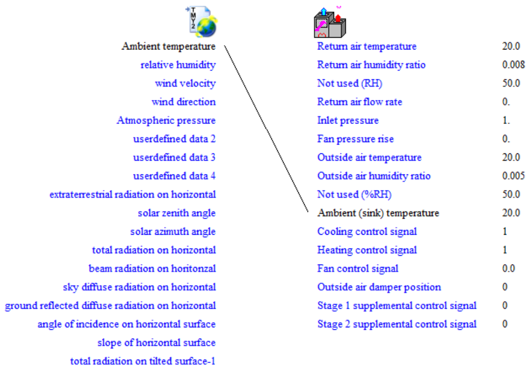
Εικόνα 4.21: Συνδεσμολογία Weather data – Heat Pump
