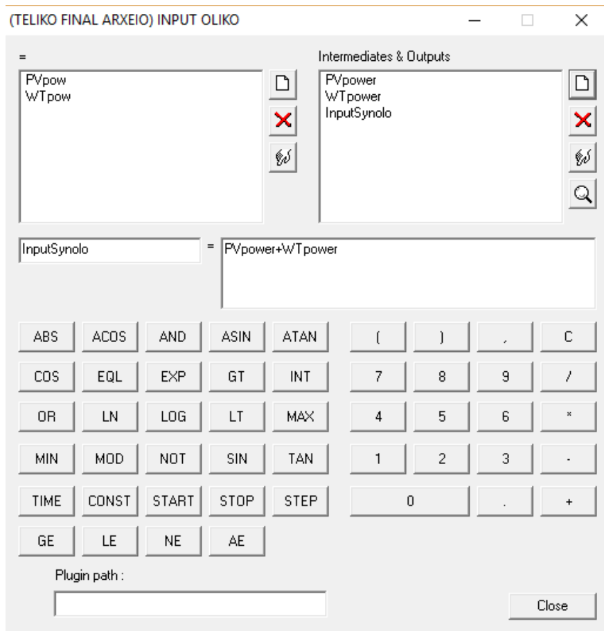
Εικόνα 4.77: Άθροιση παραγωγής Type90 και Type 94a
