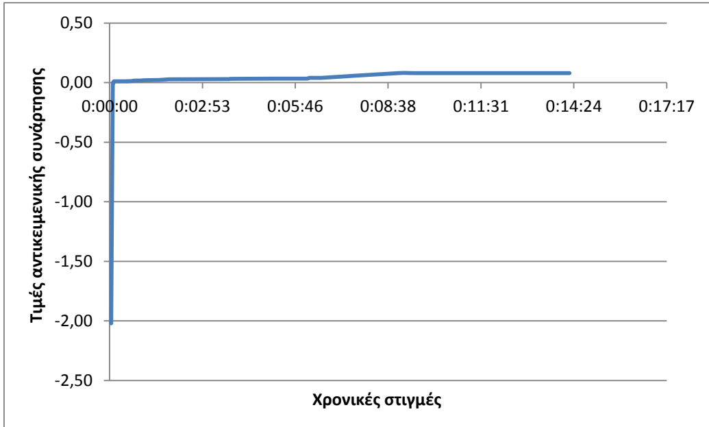
Σχήμα 6.3: Μεταβολή της τιμής της αντικειμενικής συνάρτησης ανάλογα με το χρόνο για συνδυασμό παραμέτρων: Πληθ.: 30, Βαθμ. Διαστ.: 0,6, Βαθμ. Μετάλ.: 0,05
