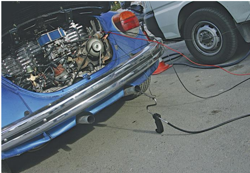
Σχήμα 1.6: Τοποθέτηση ακροφύσιου στην εξάτμιση του οχήματος
