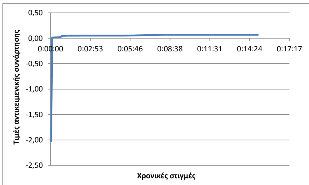
Σχήμα 6.2: Μεταβολή της τιμής της αντικειμενικής συνάρτησης ανάλογα με το χρόνο για συνδυασμό παραμέτρων: Πληθ.: 30, Βαθμ. Διαστ: 0,2, Βαθμ. Μετάλ.: 0,05
