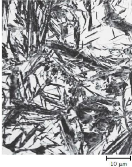
Εικόνα 23: Μαρτενσιτική μικροδομή που έχει αναπτυχθεί σε βελόνες. Οι λευκές περιοχές στο εσωτερικό της είναι υπολειπόμενος ωστενίτης [4].
