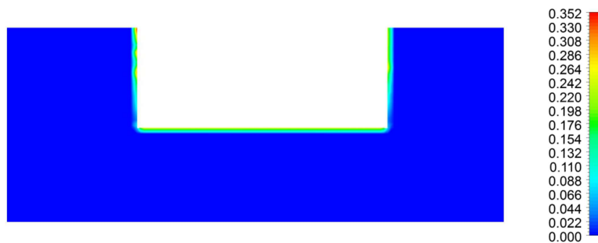
Σχήμα 6.41: Συγκέντρωση φυσαλίδων CO στην περιοχή γύρω από ένα ηλεκτρόδιο ( \text{kg/m}^3 )
