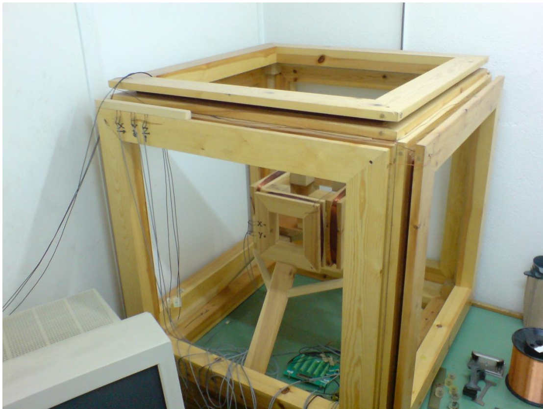
Σχήμα 9.1: Η συνολική διάταξη του αισθητήρα μέτρησης διδιάστατων μαγνητικών πεδίων υψηλής ευαισθησίας. Διακρίνονται τα εσωτερικά 2D ζεύγη Helmholtz για τη διέγερση και τα εξωτερικά 3D ζεύγη Helmholtz για τον μηδενισμό του μαγνητικού πεδίου της γης και την εφαρμογή του προς μέτρηση μαγνητικού πεδίου [55]
