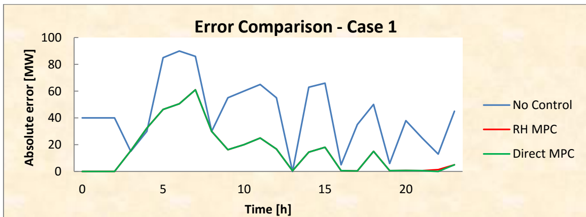
Σχήμα 5-8 Συγκριτικό διάγραμμα σφαλμάτων πριν και μετά την εφαρμογή των τεχνικών ελέγχου.
