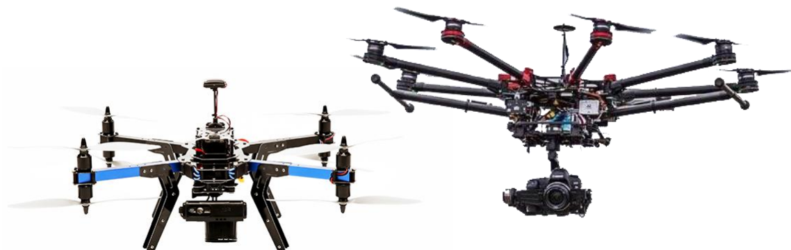
Εικόνα 2.3: UAV πολλών στροφείων. (Αριστερά το τετρακόπτερο X8M 3D Robotics, δεξιά χειροποίητο οκτακόπτερο)
