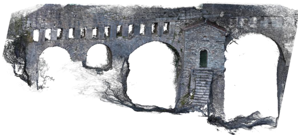
Εικόνα 4.17: Σχεδόν ακατέργαστο νέφος σημείων από την Mobius
