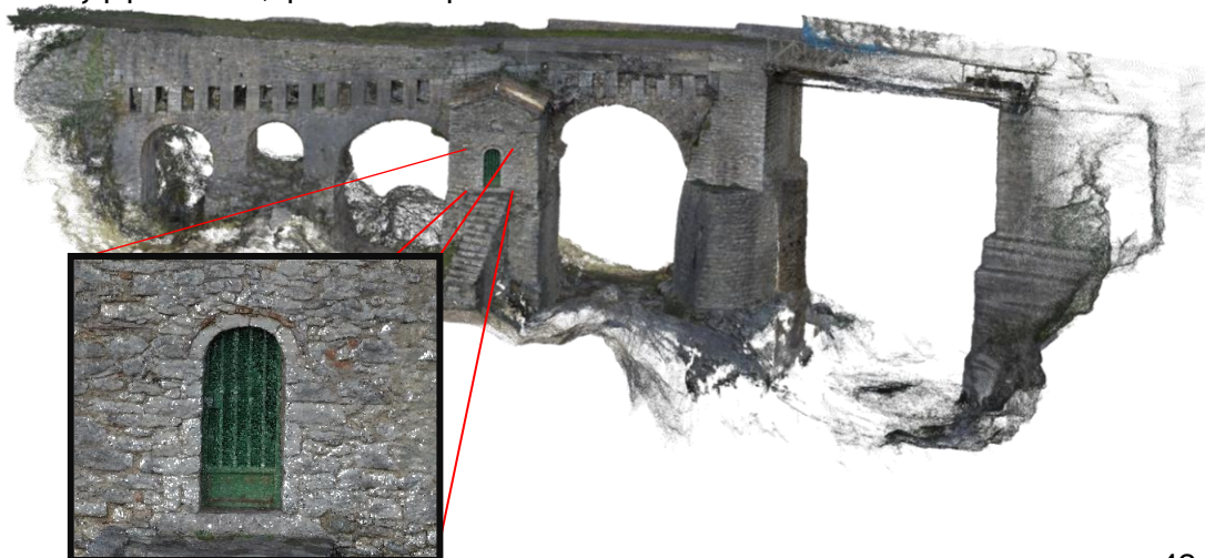
Εικόνα 4.16: Τελικό επεξεργασμένο νέφος σημείων από GoPro. Υψηλό επίπεδο λεπτομέρειας
