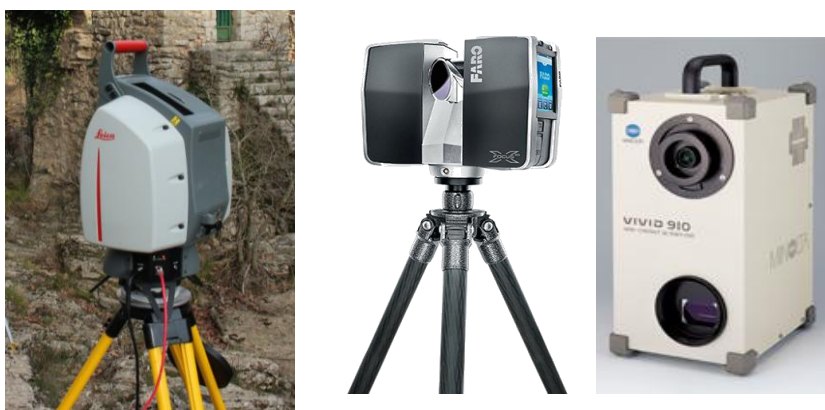
Εικόνα 1.1: Συσκευές σάρωσης. Σαρωτές laser time-of-flight, διαφοράς φάσης, τριγωνισμού (από αριστερά προς δεξιά)
