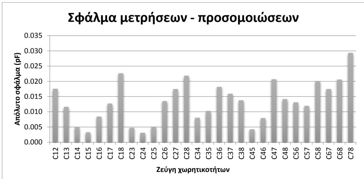
Σχήμα 7.10 Απόλυτο σφάλμα μεταξύ προσομοίωσης και μέτρησης. Μέτρηση νερό – αέρας
