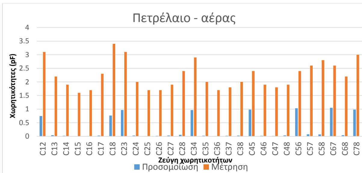
Σχήμα 7.4 Χωρητικότητες αισθητήρα για μέτρηση πετρελαίου – αέρα
