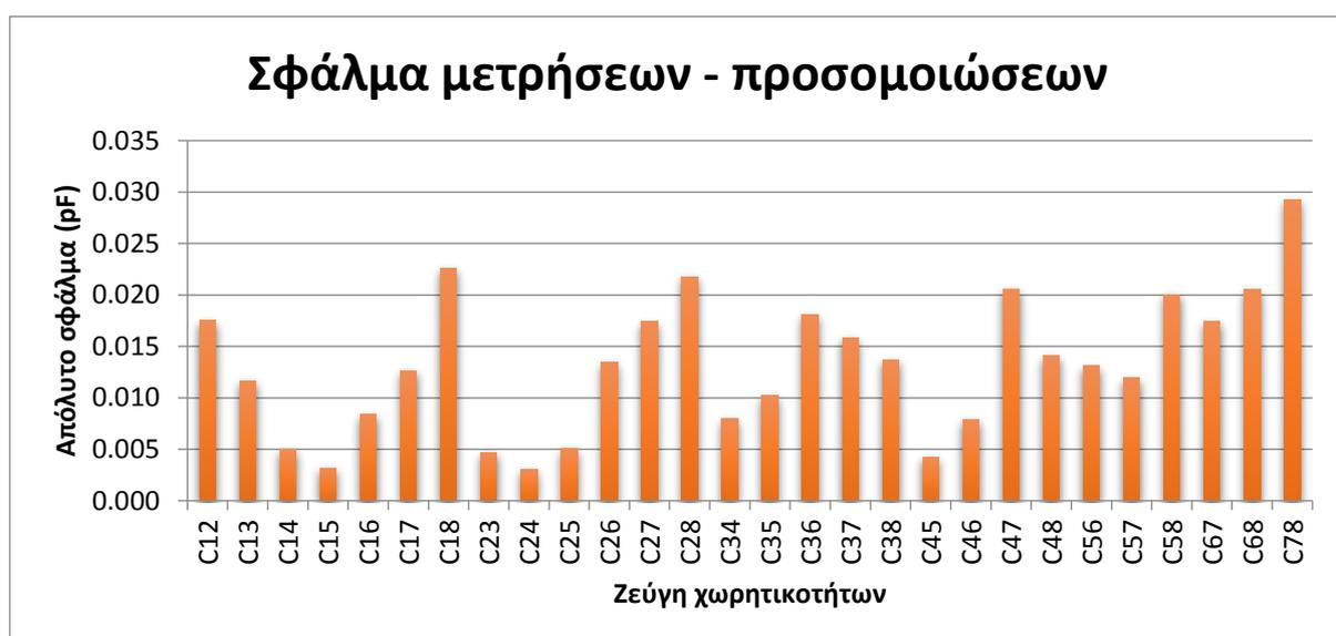
Σχήμα 7.14 Απόλυτο σφάλμα μεταξύ προσομοίωσης και μέτρησης. Μέτρηση πετρέλαιο - νερό
