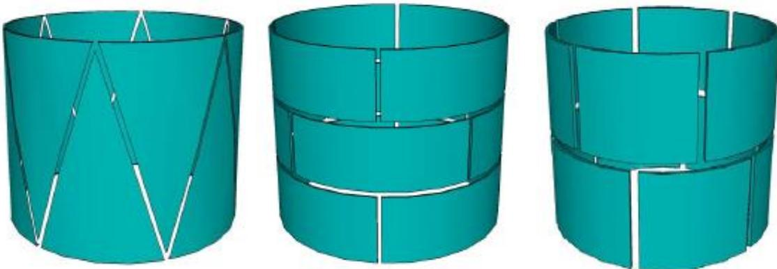
Σχήμα 4.2 Τρεις διαφορετικοί σχηματισμοί ενός αισθητήρα τρισδιάστατης τομογραφίας ECVT. Αριστερά είναι ένας αισθητήρας ενός επιπέδου τριγωνικής τοπολογίας, ενώ οι υπόλοιποι είναι ορθογώνιοι τριών και δύο επιπέδων αντίστοιχα [55].
