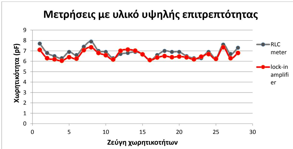
Σχήμα 7.2 Σύγκριση μετρήσεων lock-in ενισχυτή και LCR meter. Υλικό υψηλής επιτρεπτότητας
