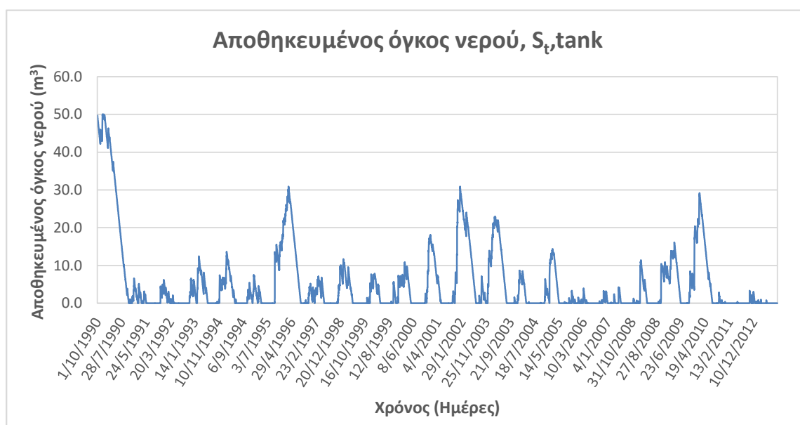
Σχήμα 5.1: Αποθηκευμένος όγκος νερού στην δεξαμενή συλλογής νερού για N_{cap}=4 , p=35\% , q=150 L/day/κάτοικο , A=120 m^2 και V_{tank}=50 m^3 .
