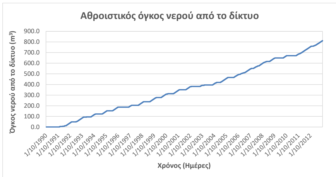
Σχήμα 5.4: Αθροιστικός όγκος νερού που παρέχεται από το δίκτυο για N_{cap}=4 , p=35\% , q=150 L/day/κάτοικο, A=120 m 2 και V_{tank}=50 m 3 .
