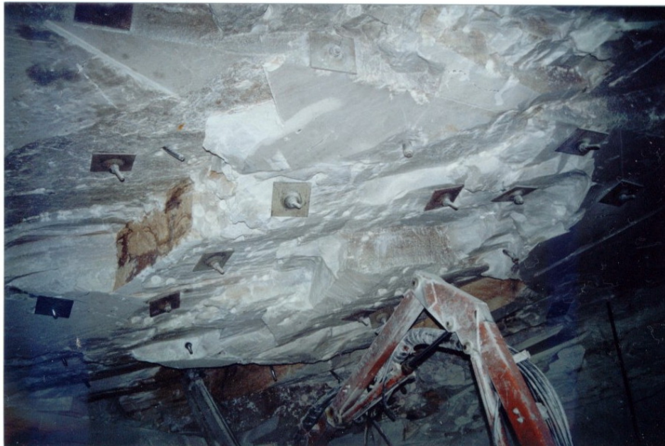
Εικόνα 5.2 Κοχλίωση οροφής στο λατομείο Διονύσου (στοιχεία από την Α.Ε.Β.Ε Λατομείων Μαρμάρου Διονύσου-Πεντέλης)
