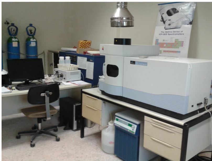
Εικόνα 9.1: Φασματόμετρο ICP-OES που χρησιμοποιήθηκε, μοντέλο Optima 7000DV Perkin Elmer Διαδοχικής ανάλυσης
