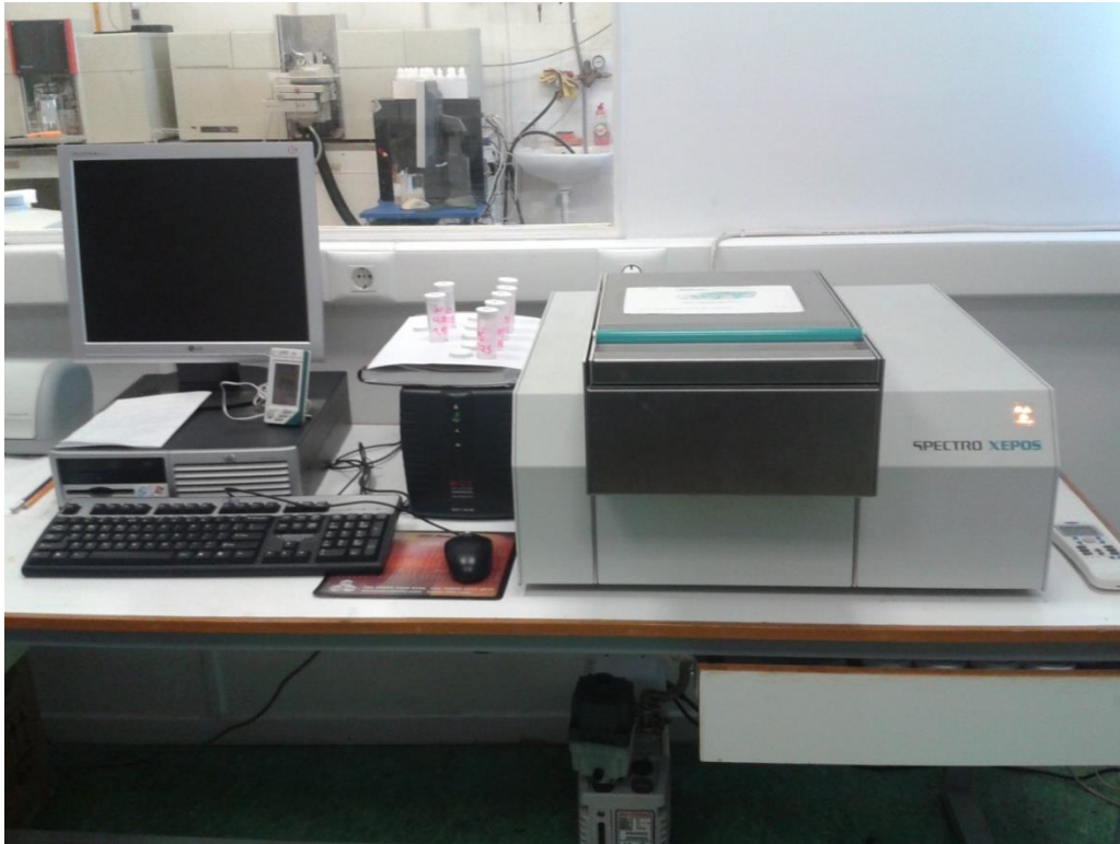
Εικόνα 9.2: Φασματόμετρο φορτισμού ακτίνων X (XRF) SPECTRO XEPOS της εταιρίας SPECTRO ANALYTICAL INSTRUMENTS
