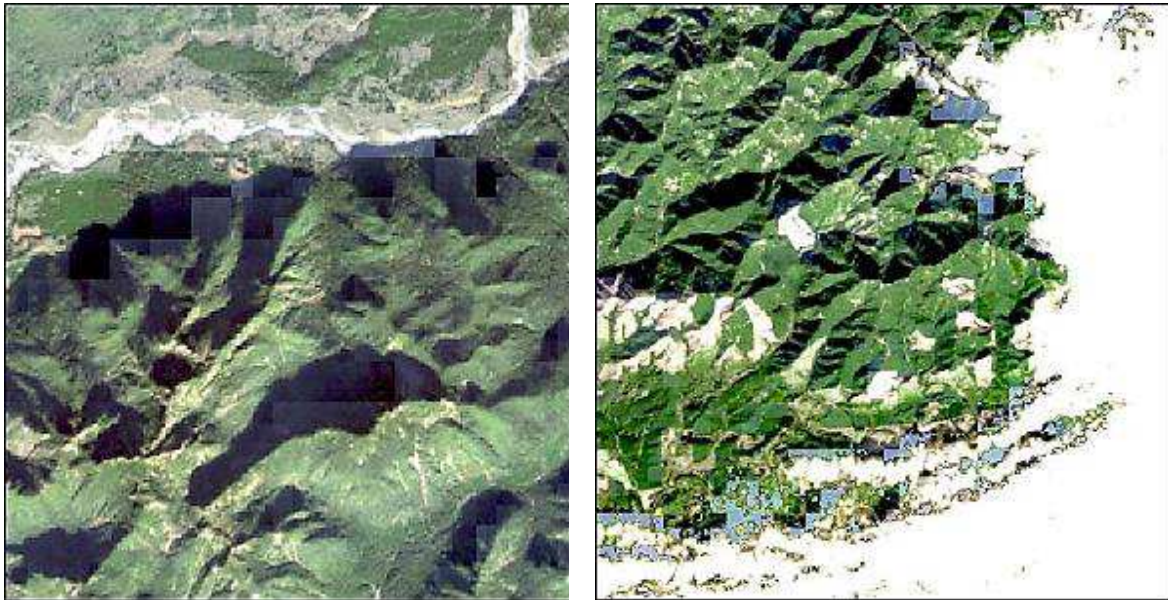
Εικόνα 7: Ατέλειες αλγορίθμου L8 SR απότομες υψομετρικές διαφορές (αριστερά)
