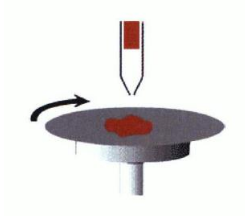
Εικόνα 2-9: Επίστρωση υμενίων με την τεχνική spin-coating
