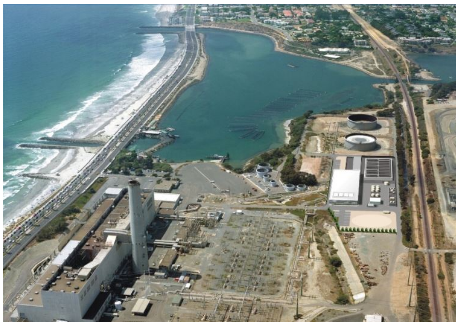
Σχήμα 1-1: Από τις μεγαλύτερες μονάδες αφαλάτωσης στον κόσμο, στο Carlsbad της California, USA, κατασκευασμένη να παρέχει 190,000 m 3 νερού ανά ημέρα. ( http://carlsbaddesal.sdcwa.org )
