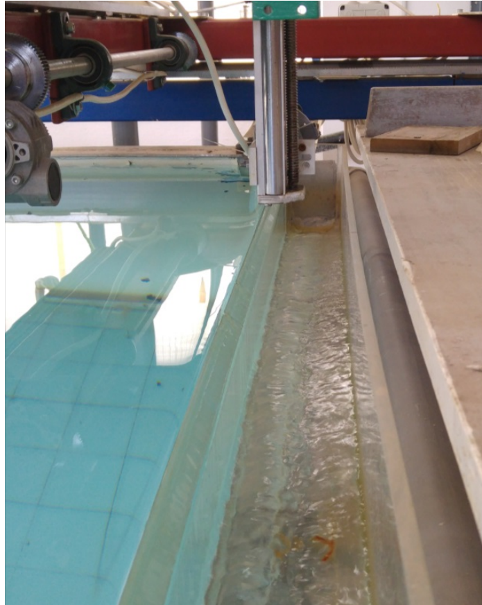
Σχήμα 3-3: Υπερχειλιστής δεξαμενής διάχυσης
