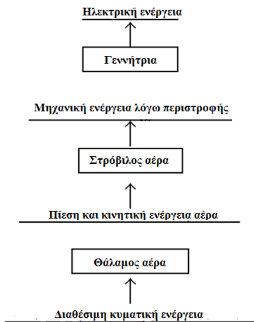
Διάγραμμα 4. 1 - Διάγραμμα ροής μετατροπής κυματικής ενέργειας σε ηλεκτρική μέσω OWC
