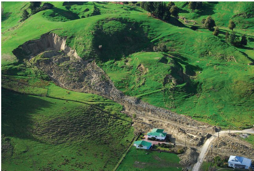
Εικόνα 2.3 Βαθιά περιστροφική ολίσθηση γαιών (αριστερό τμήμα) που εξελίχθηκε σε ροή γαιών (δεξιό τμήμα). Εκδηλώθηκε στο Hunterville τον Ιούλιο του 2006 λόγω βροχοπτώσεων. Η εν λόγω ολίσθηση, οδήγησε στην προσωρινή εκκένωση 4 σπιτιών (Saunders & Glassey, 2007).
