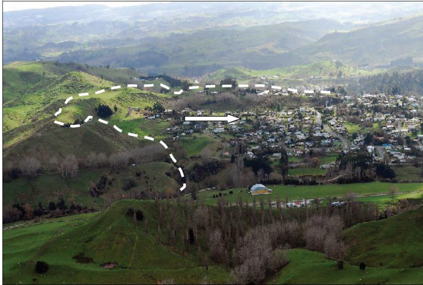
Εικόνα 2.2: Μεταθετική ολίσθηση στη Taihape. Το βέλος υποδεικνύει τη φορά μετακίνησης ενώ σημειώνονται και τα όρια της κατολίσθησης (Saunders & Glassey, 2007).
