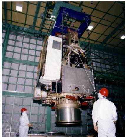
**Σχήμα 2.5:** Κατασκευή του δορυφόρου TRMM στο κέντρο GFSC [Πηγή: <http://pmm.nasa.gov/multimedia/images/TRMM>].
