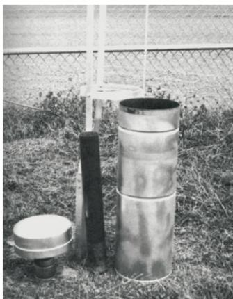
**Σχήμα 2.1:** Τυπικό βροχόμετρο [Πηγή: Μπαλτάς, 2013].
