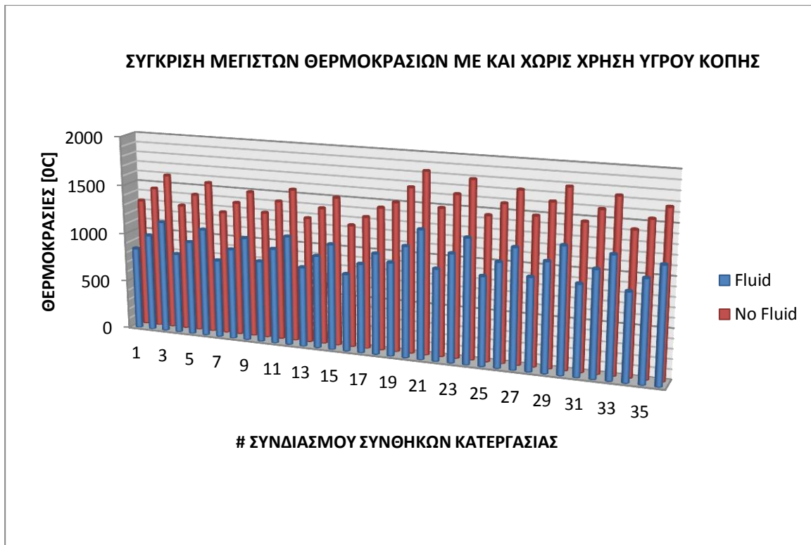
Διάγραμμα σύγκρισης μέγιστων θερμοκρασιών κατεργασίας, με και χωρίς τη χρήση υγρού κοπής [Σχήμα 9.5]
