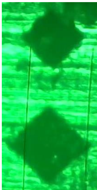
Σχήμα 30. Αποτυπώματα σκληρόμετρου με διαφορετικό μέγεθος.
