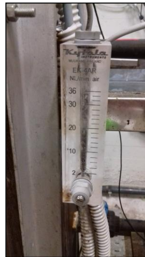
Σχήμα 4.18: Όργανο για την ένδειξη του παρεχόμενου οξυγόνου
