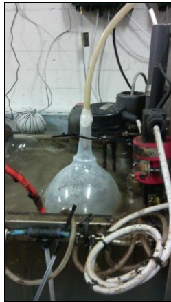
Σχήμα 4.21: Αυτοσχέδια κατασκευή για τη συλλογή του πτητικοποιημένου υδροκυανίου (MBR1)
