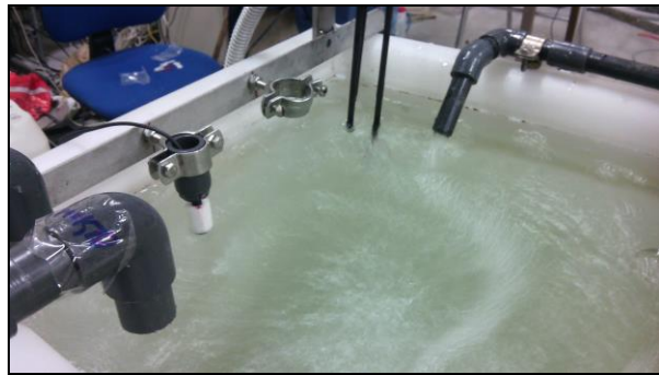
Σχήμα 4.15: Υποδοχές αισθητήρων για τον έλεγχο ανώτατης/κατώτατης στάθμης, pH, DO, MLSS και θερμοκρασίας (MBR2)
