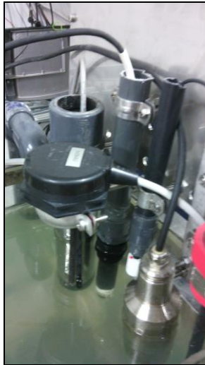
Σχήμα 4.14: Αισθητήρας για τον έλεγχο ανώτατης/κατώτατης στάθμης, pH, DO, MLSS και θερμοκρασίας (MBR1)
