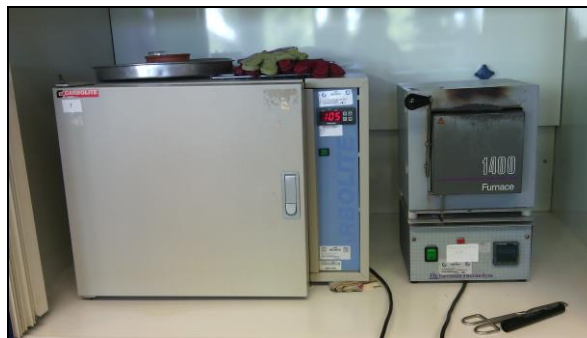
Σχήμα 4.34: Φούρνος των 105°C Carbolite (αριστερά) και φούρνος των 550°C Furnace 1400 Barnstead Thermolyne (δεξιά)
