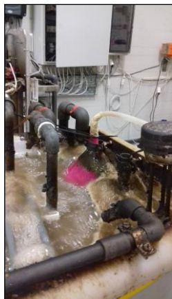
Σχήμα 4.23: Αυτοσχέδια κατασκευή για τη συλλογή του πτητικοποιημένου υδροκυανίου (MBR2)
