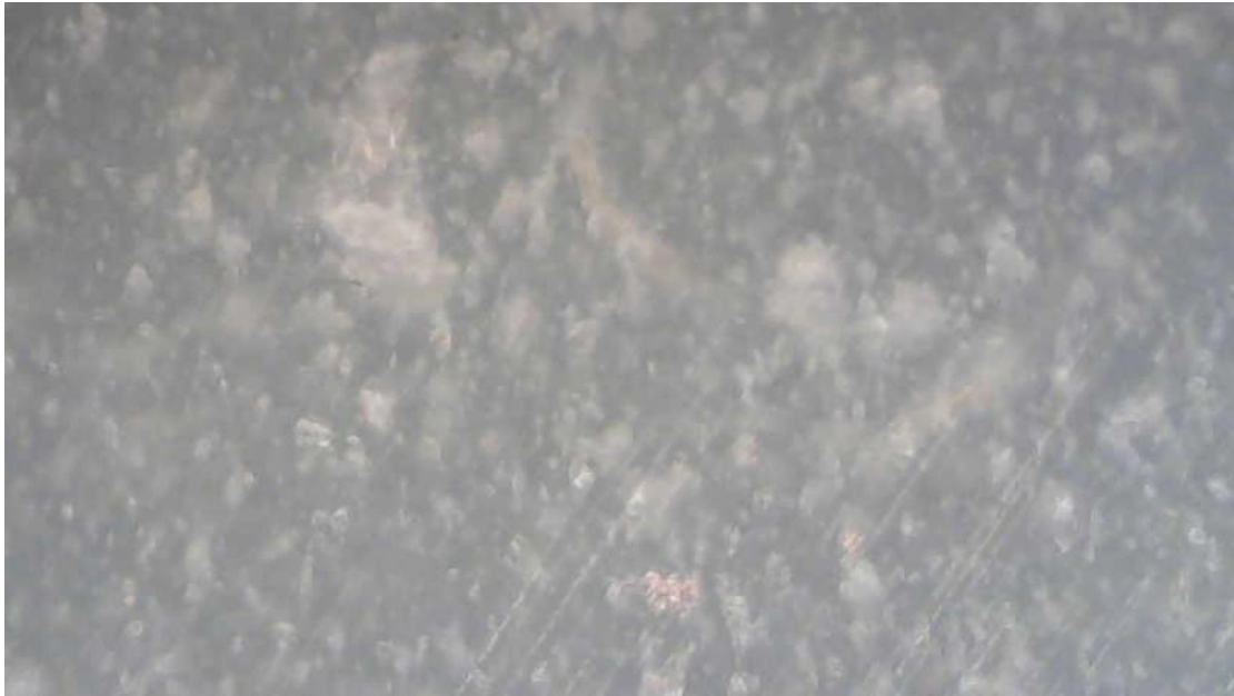
Σχήμα 10-15: Εγκάρσια τομή HDPE 2% σε κλίμακα 10x.
