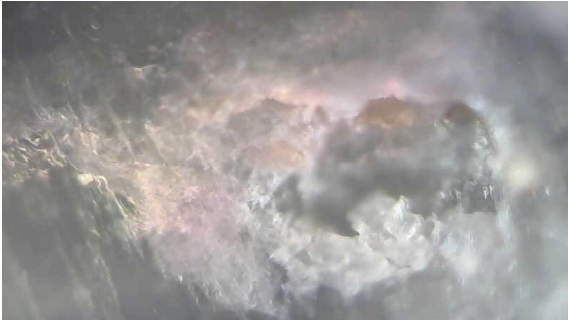
Σχήμα 10-23: Εγκάρσια τομή HDPE 3% σε κλίμακα 20x
