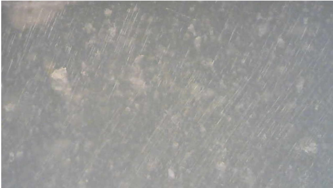
Σχήμα 10-13: Εγκάρσια τομή HDPE 2% σε κλίμακα 5x.
