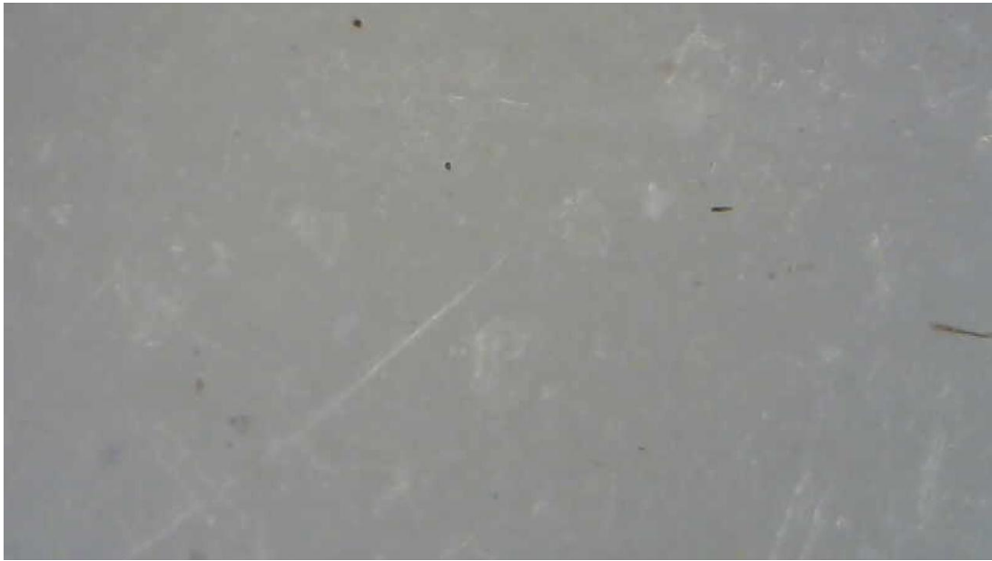
Σχήμα 10-5: Εξωτερική επιφάνεια HDPE 1% σε κλίμακα 5x.
