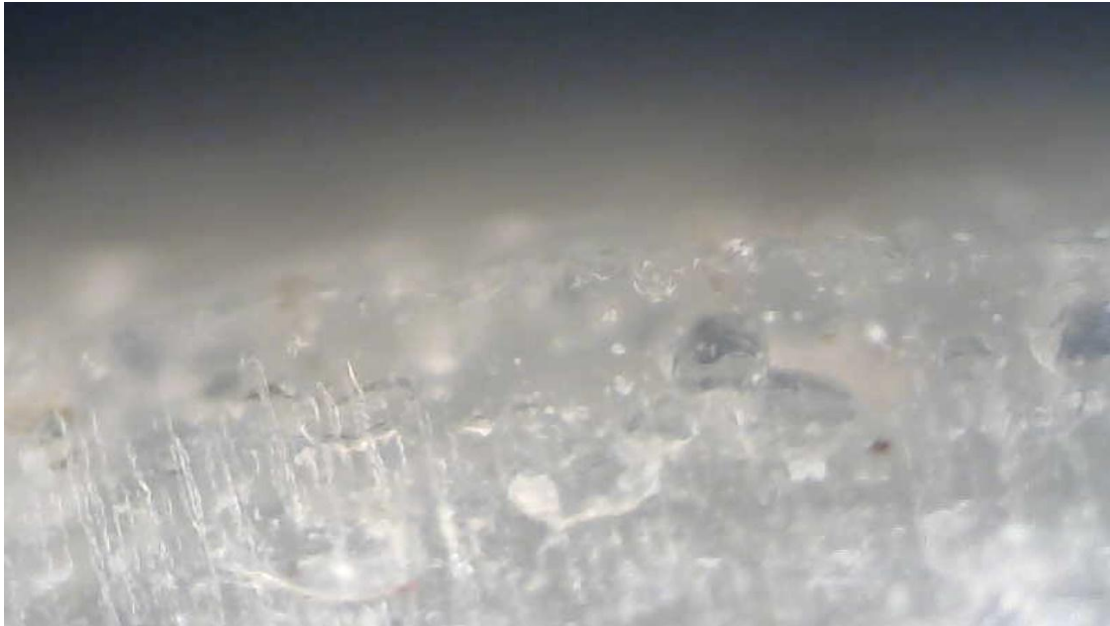
Σχήμα 10-21: Εγκάρσια τομή HDPE 3% σε κλίμακα 10x
