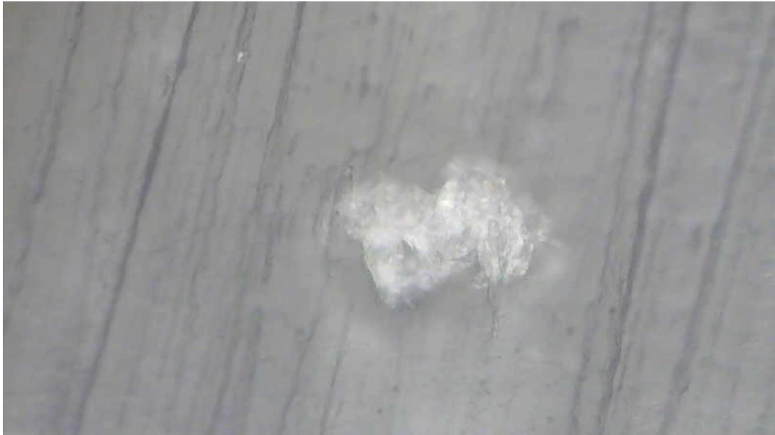
Σχήμα 10-11: Εγκάρσια τομή HDPE 1% σε κλίμακα 50x.
