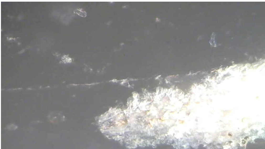
Σχήμα 10-28: Εγκάρσια τομή HDPE 4% σε κλίμακα 20x
