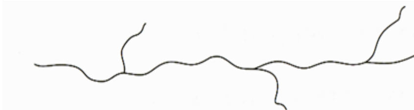
Σχήμα 2-32: Πολυαιθυλένιο υψηλής πυκνότητας HDPE
