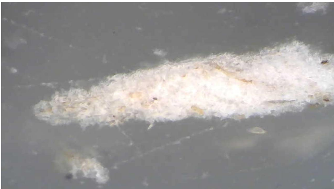
Σχήμα 10-26: Εγκάρσια τομή HDPE 4% σε κλίμακα 10x
