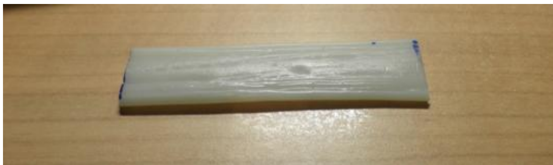
Σχήμα 9-7: Μορφοποιημένο δοκίμιο hdpe ορθογώνιου σχήματος
