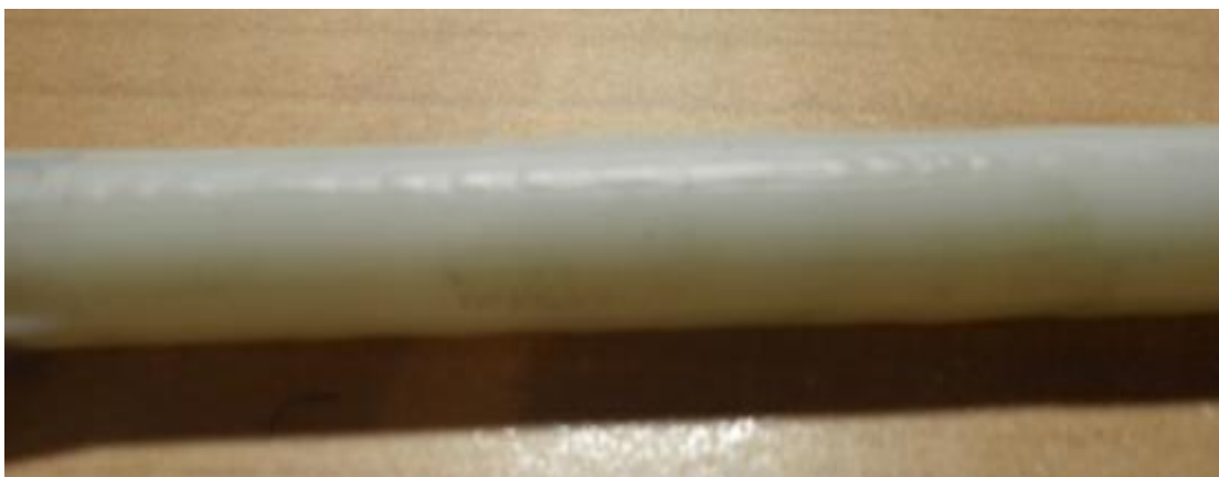
Σχήμα 9-2: Δείγμα hdpe συγκέντρωσης 1%
