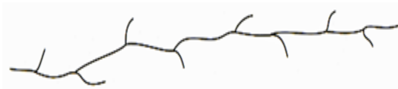
Σχήμα 2-33: Γραμμικό πολυαιθυλένιο χαμηλής πυκνότητας LLDPE
