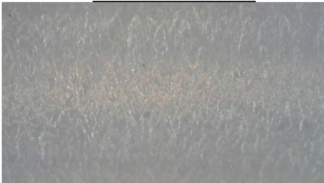
Σχήμα 10-1: Εξωτερική επιφάνεια καθαρού πολυαιθυλενίου σε κλίμακα 5x
