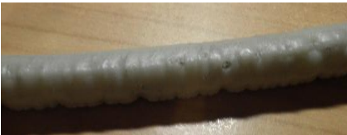
Σχήμα 9-5: Δείγμα hδpe συγκέντρωσης 4%
