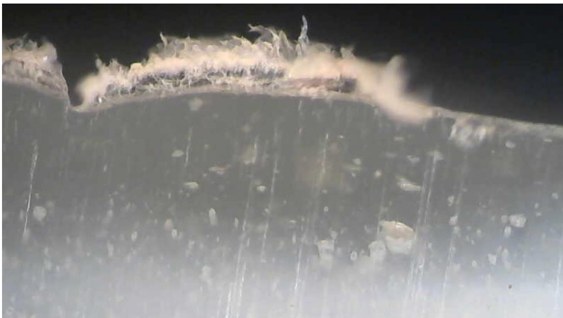
Σχήμα 10-8: Εγκάρσια τομή HDPE 1% σε κλίμακα 10x.
