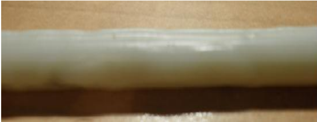
Σχήμα 9-3: Δείγμα hδpe συγκέντρωσης 2%
