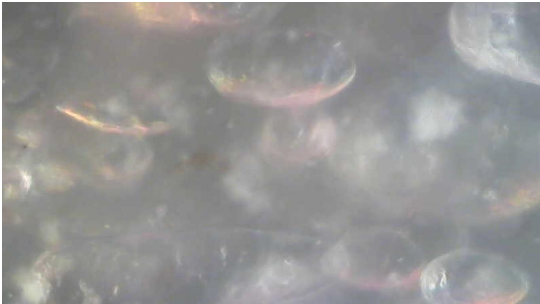
Σχήμα 10-22: Εξωτερική επιφάνεια HDPE 3% σε κλίμακα 20x.
