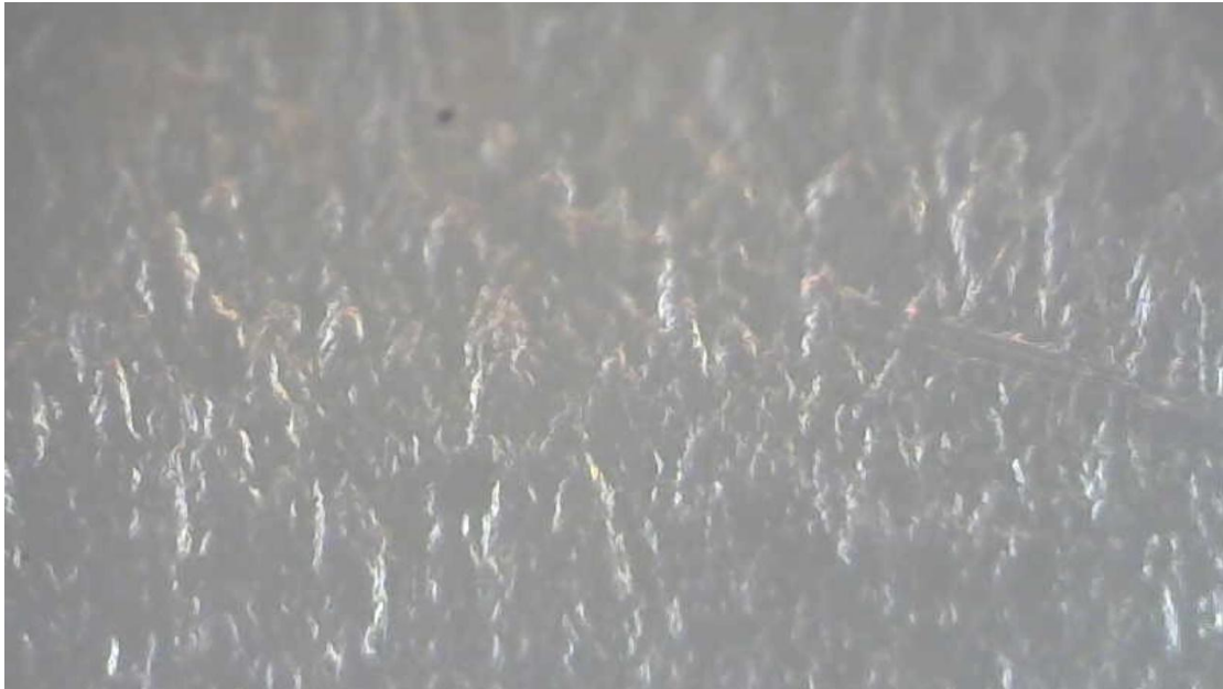
Σχήμα 10-3: Εξωτερική επιφάνεια καθαρού πολυαιθυλενίου σε κλίμακα 10x.
