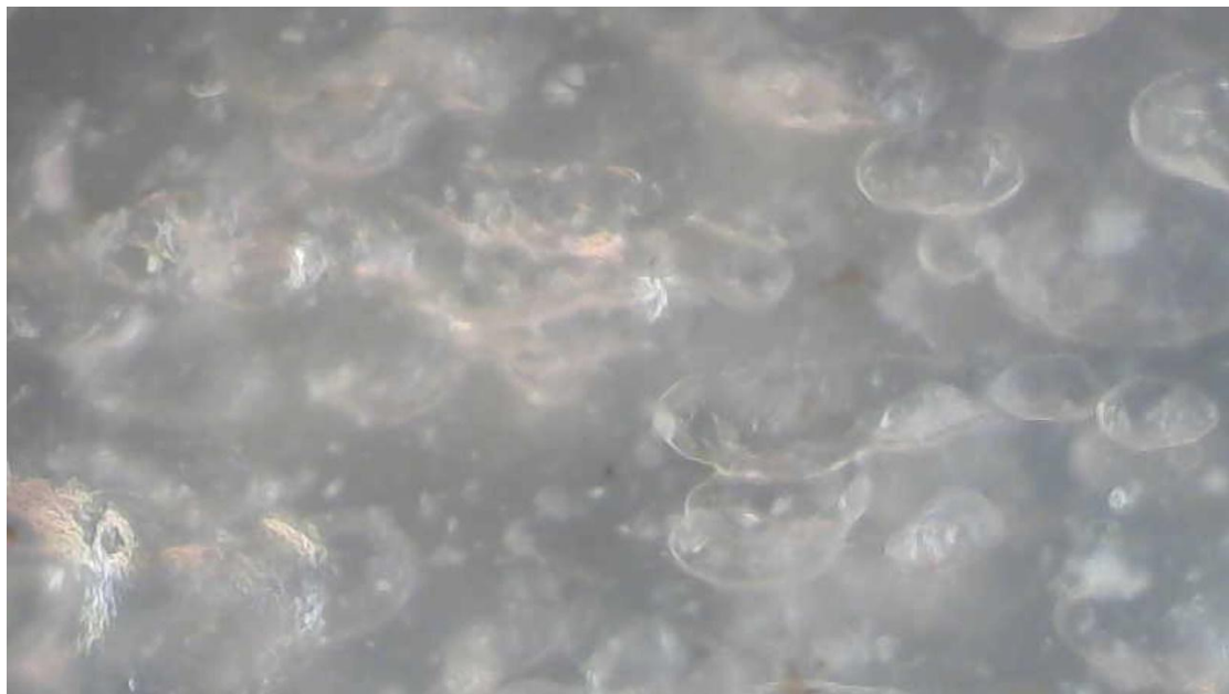
Σχήμα 10-20: Εξωτερική επιφάνεια HDPE 3% σε κλίμακα 10x.
