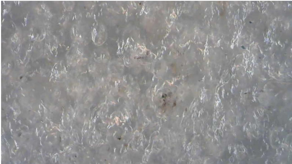
Σχήμα 10-24: Εξωτερική επιφάνεια HDPE 4% σε κλίμακα 5x.
