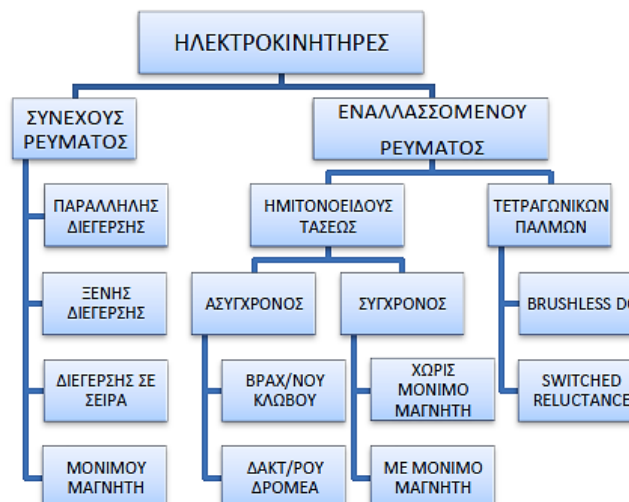
Σχήμα 28 Κατηγοριοποίηση ηλεκτρικών κινητήρων
