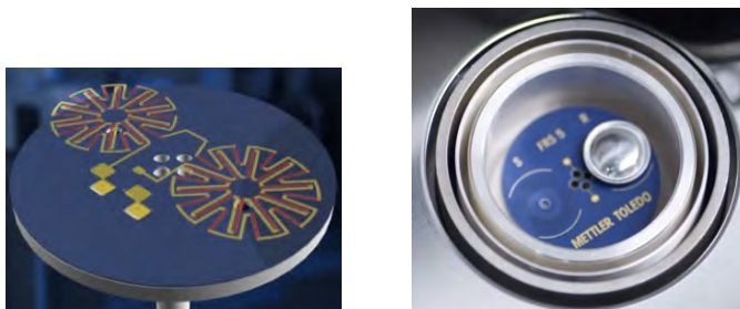
Σχήμα 3.7: Θερμοστοιχία συνδεσμολογίας τεθλασμένου αστέρα στην βάση του σημείου τοποθέτησης του δείγματος και του σημείου αναφοράς.
