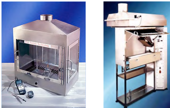
Σχήμα 3.3: Εξοπλισμός που χρησιμοποιείται για τις δοκιμές αναφλεξιμότητας και της συμπεριφοράς δαπέδων σε καύση.
