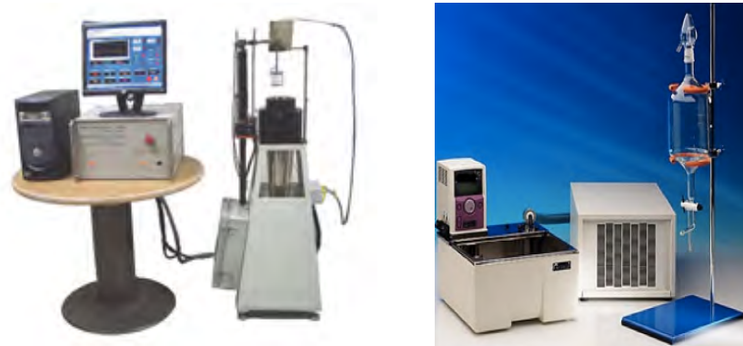
Σχήμα 3.1: Εξοπλισμός που χρησιμοποιείται για τις δοκιμές της ακαυστότητας και του προσδιορισμού της θερμαντικής αξίας.
