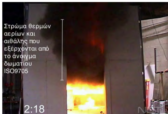
Σχήμα 5.8: Απεικόνιση της διαστρωμάτωσης των θερμών αερίων και της αιθάλης που εξέρχονται από δωμάτιο, πείραμα που διεξάχθηκε στο NIST.
