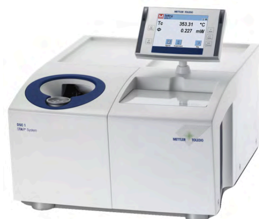
Σχήμα 3.6: Όργανο διαφορικής θερμιδομετρίας σάρωσης της εταιρίας METTLER TOLEDO.
