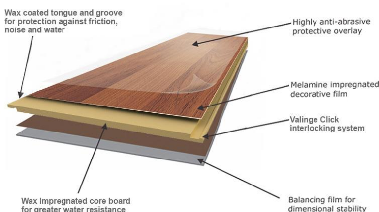
Σχήμα 6.3: Τυπική δομή ξύλινου πάνελ δαπέδου τύπου laminate.
