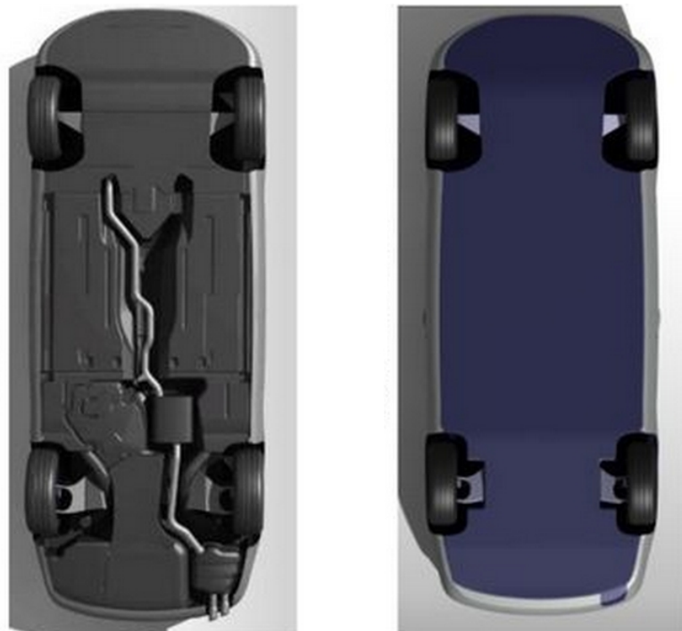
Σχήμα 2.3: Διαφορετικές διαμορφώσεις του DrivAer για το κάτω μέρος του αμαξώματος: Detailed Underbody (D) , Smooth Underbody (S) .
