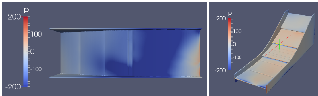
Σχήμα 3.36: Η κατανομή πίεσης στην πλευρική αεροδυναμική διάταξη του μονοθέσιου κατά τον δεύτερο σχεδιαστικό κύκλο.
