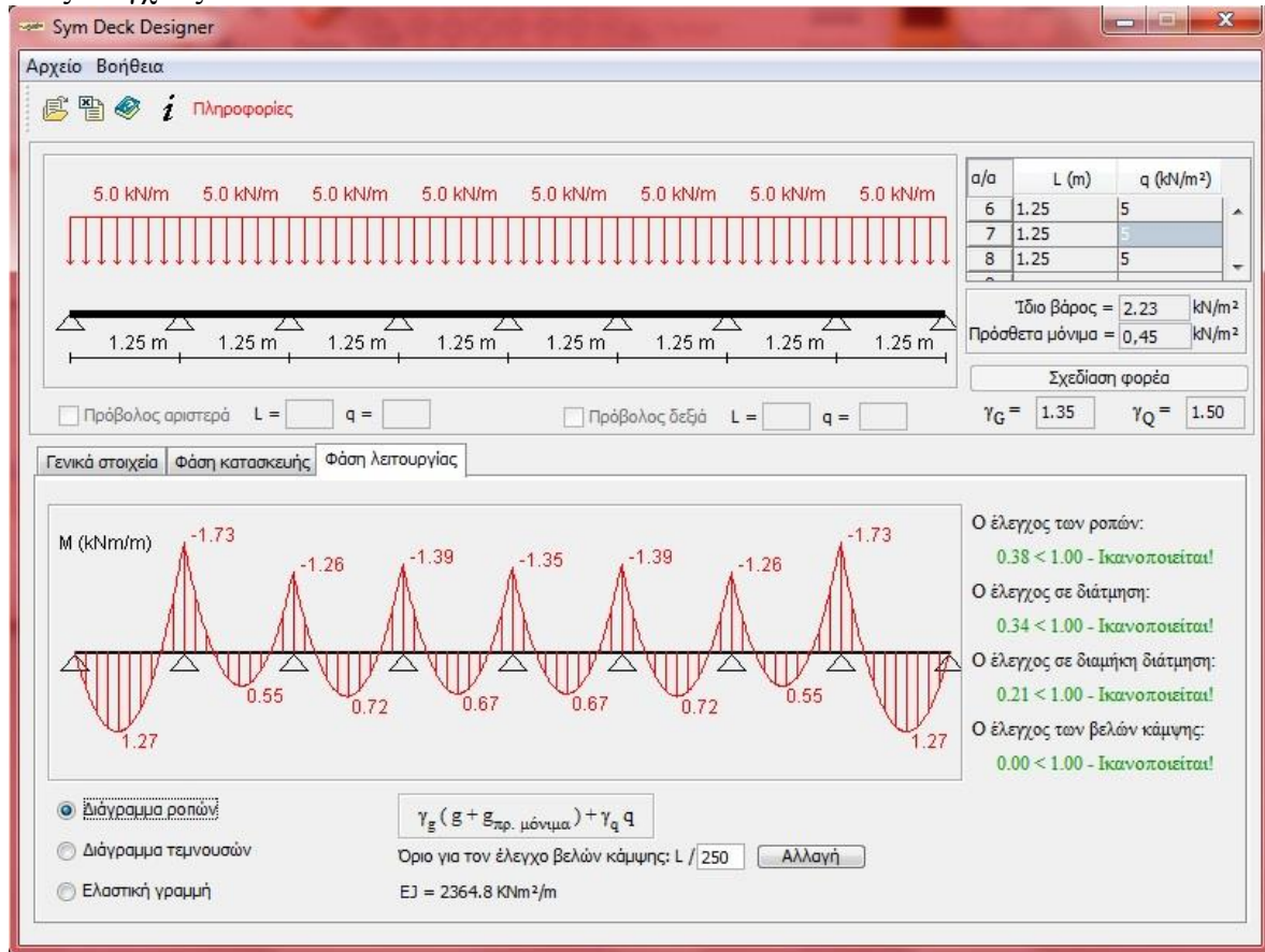
Σχήμα 3.4 Έλεγχοι της σύμμικτης πλάκας κατά τη φάση λειτουργίας
