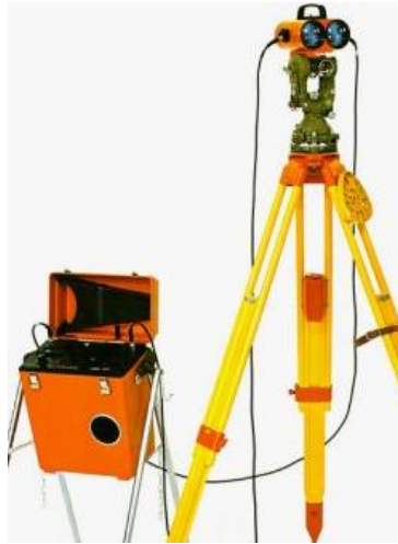
Εικόνα 1.4 Το Distomat DI 10
