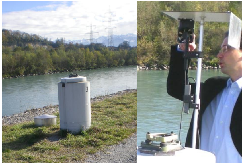
Εικόνα 3.7 Βάθρο 3 της βάσης στο Heerburg και σύστημα μέτρησης των καιρικών συνθηκών
