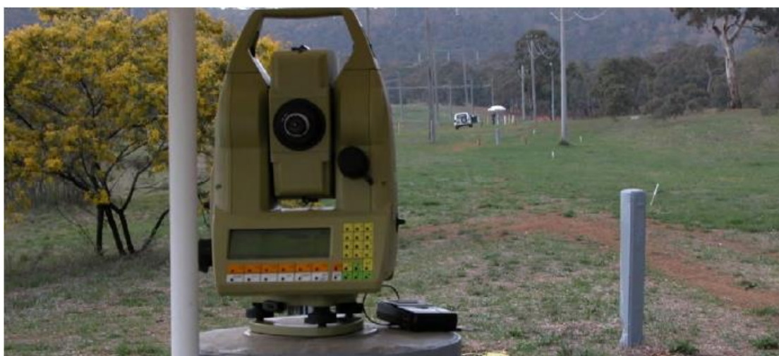
Εικόνα 3.2 Όργανο Leica TC2003 τοποθετημένο στο βάρθρο 5 (Tony Watson, Volker Janssen., 2014)
