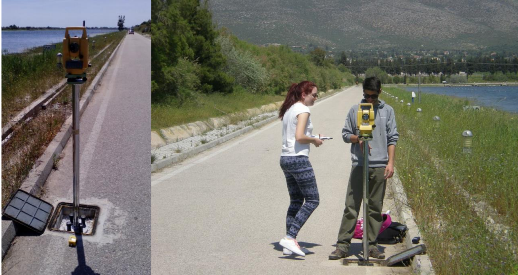
Εικόνα 4.3 Μέτρηση βάσης ελέγχου με το όργανο GTS 226 - UN 4768
