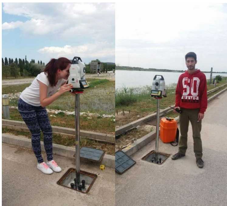
Εικόνα 3.23 Μέτρηση βάσης ελέγχου με πρότυπο όργανο
