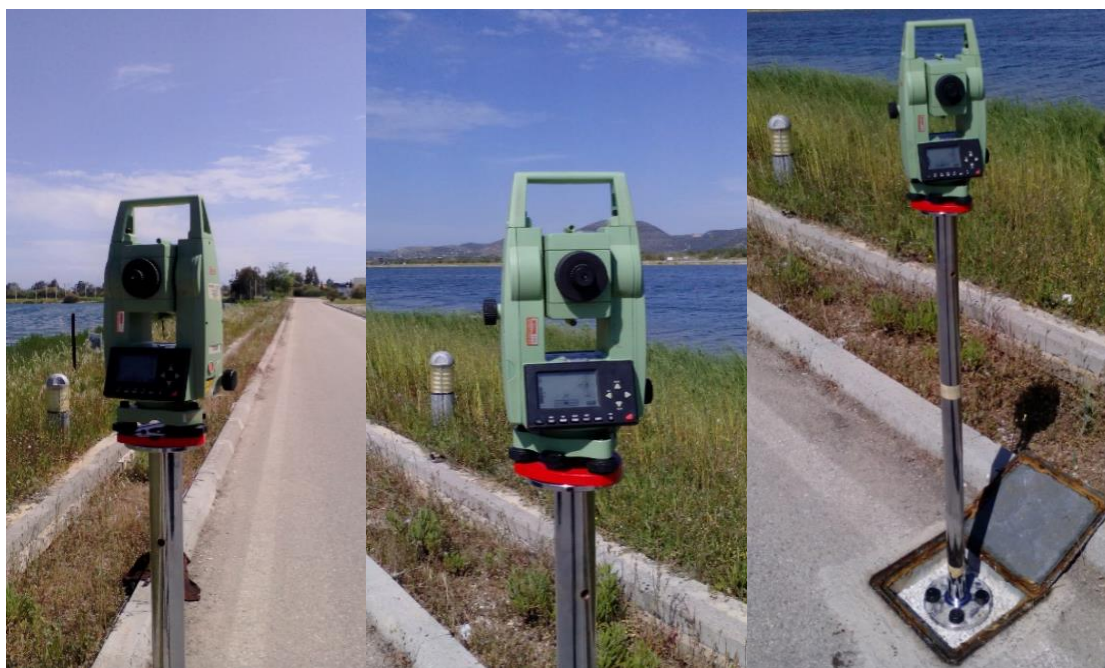
Εικόνα 4.2 Μέτρηση βάσης ελέγχου με το όργανο TCR 303
