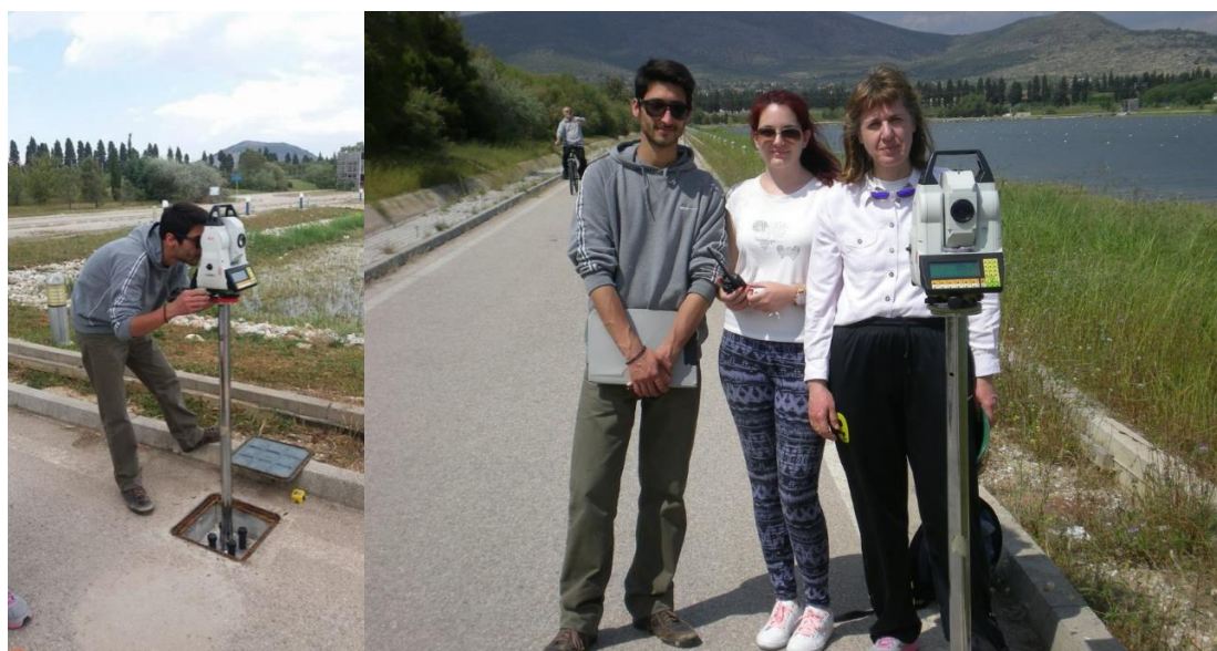
Εικόνα 3.24 Μέτρηση βάσης ελέγχου με πρότυπο όργανο
