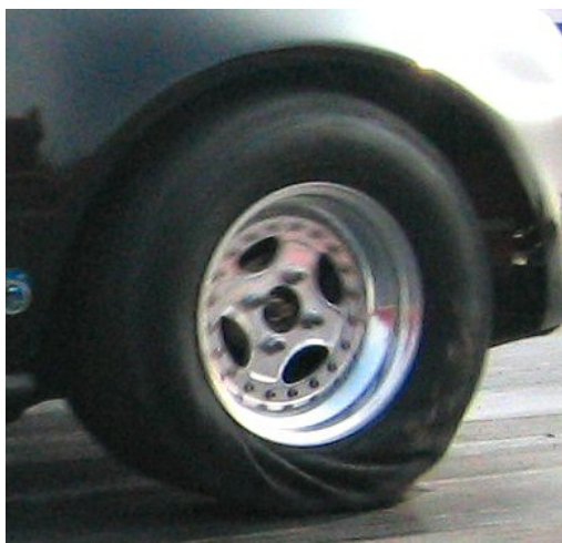
Εικόνα 2.11 - Αγωνιστικό ελαστικό παραμορφωμένο υπό ροπή επιτάχυνσης
