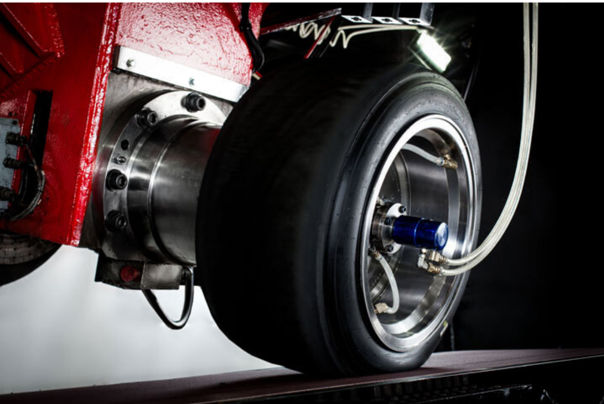
Εικόνα 2.16 - Πειραματική διάταξη μετρήσεων χαρακτηριστικών λειτουργίας ελαστικών
