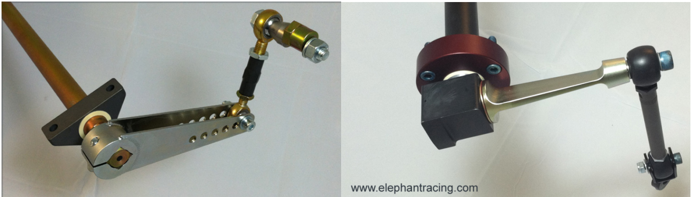
Εικόνα 2.26 - Παραδείγματα ρυθμιζόμενων αντιστρεπτικών ράβδων, (αριστερά) με διαφορετικά μήκη σύνδεσης και (δεξιά) με περιστρεφόμενα -μεταβλητής δυσκαμψίας- άκρα
