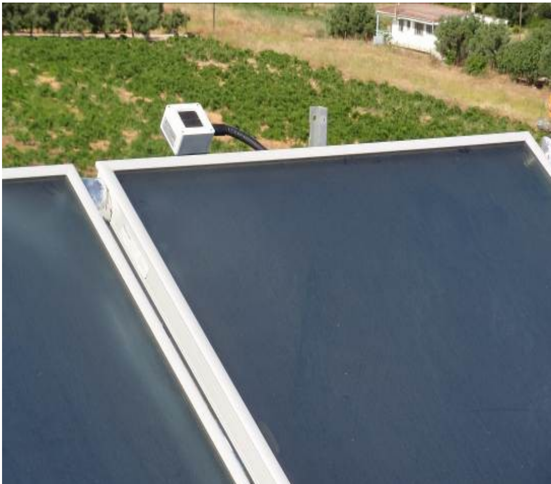
Εικόνα 3.1 Τοποθέτηση πυρανόμετρου στο ηλιακό πεδίο
