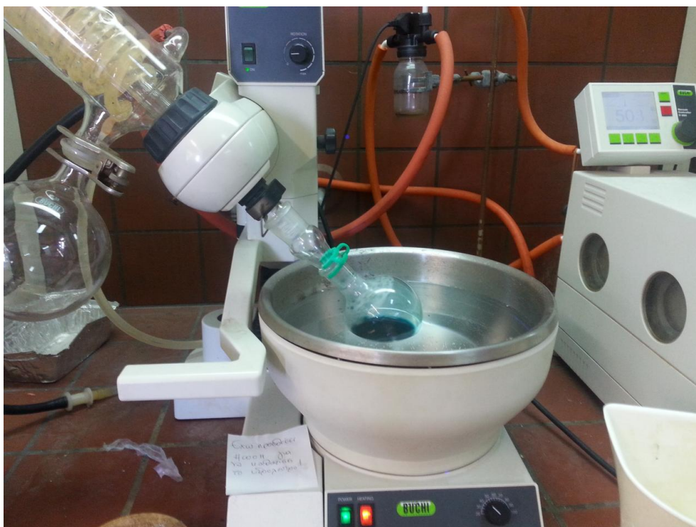
Εικόνα 48 παρασκευή νανοσωματιδίων σε ήπια περιστροφή σε συσκευή rotary.
