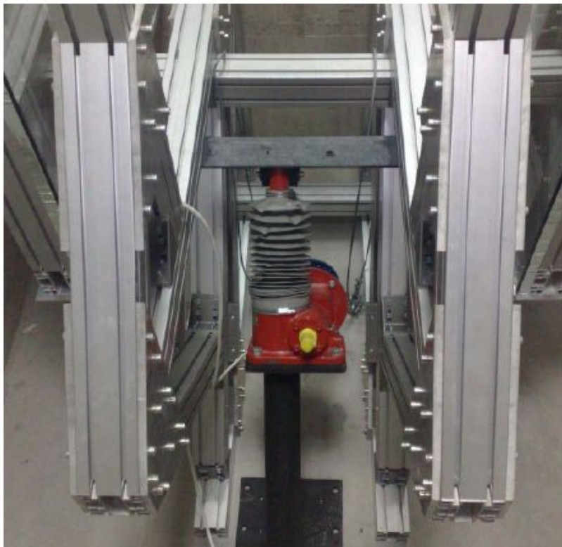
Εικόνα 6.2: Το ηλεκτρικό έμβολο (screw jack) της συσκευής, συνδεδεμένο με το κινητό μέρος της συσκευής προσομοίωσης διάρρηξης ρήγματος.
