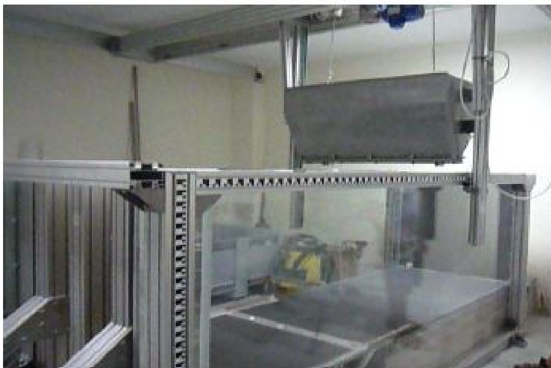
Εικόνα 6.4: Φωτογραφία της Συσκευής Ελεγχόμενης Διάστρωσης Άμμου εν λειτουργία, αμέσως μετά την έναρξη διάστρωσης εντός του κιβωτίου της Συσκευής Προσομοίωσης Σεισμικής Διάρρηξης.
