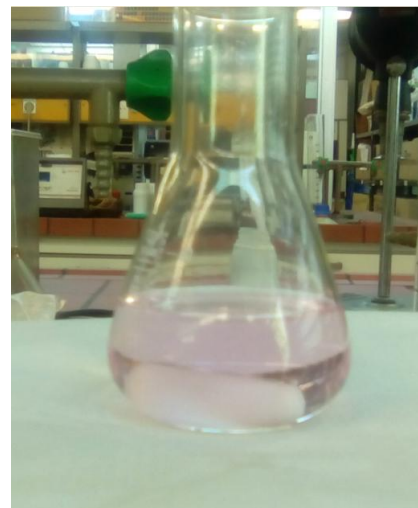
Εικόνα 2.1. Ανίχνευση τελικού σημείου
