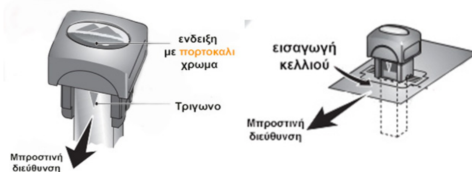
Εικόνα 40 : Ορθός τρόπος τοποθέτησης κελιού
