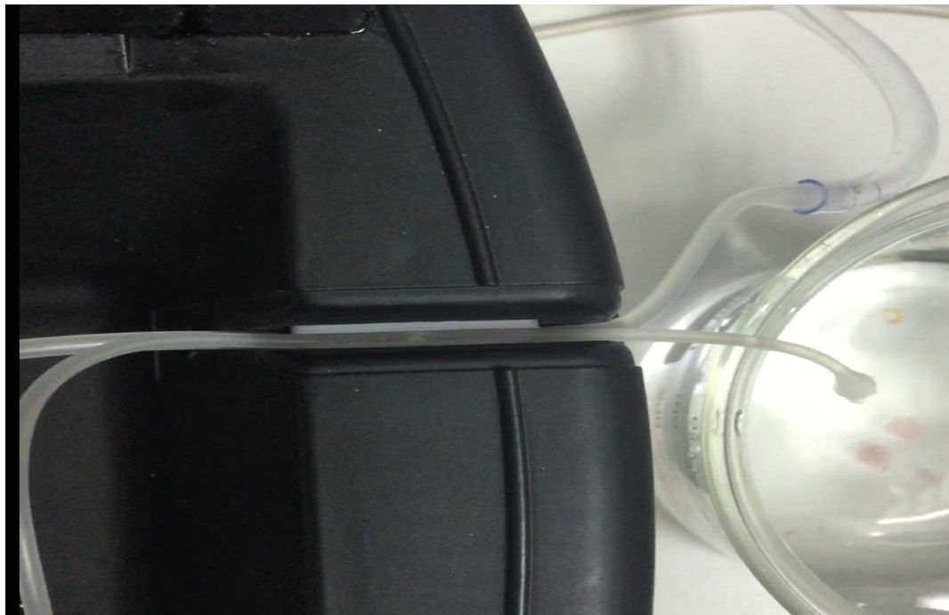
Εικόνα 43 : Έλεγχος της ροής από και προς το κελί με τη χρήση της βαλβίδας του οργάνου
