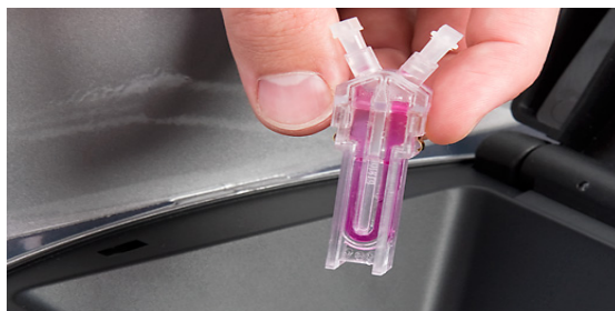
Εικόνα 36 : Πρότυπος τρόπος μεταχείρισης folded capillary cell
