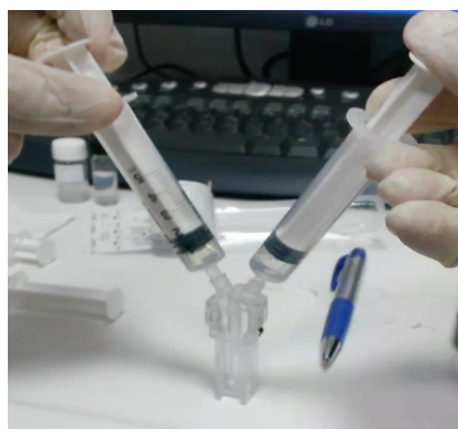
Εικόνα 37 : Καθαρισμός folded capillary cell
