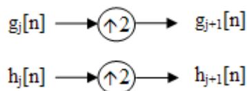
Εικόνα 14: Σε κάθε επίπεδο ανάλυσης αυξάνουμε την δειγματοληψία της εξόδου των φίλτρων κατά 2
