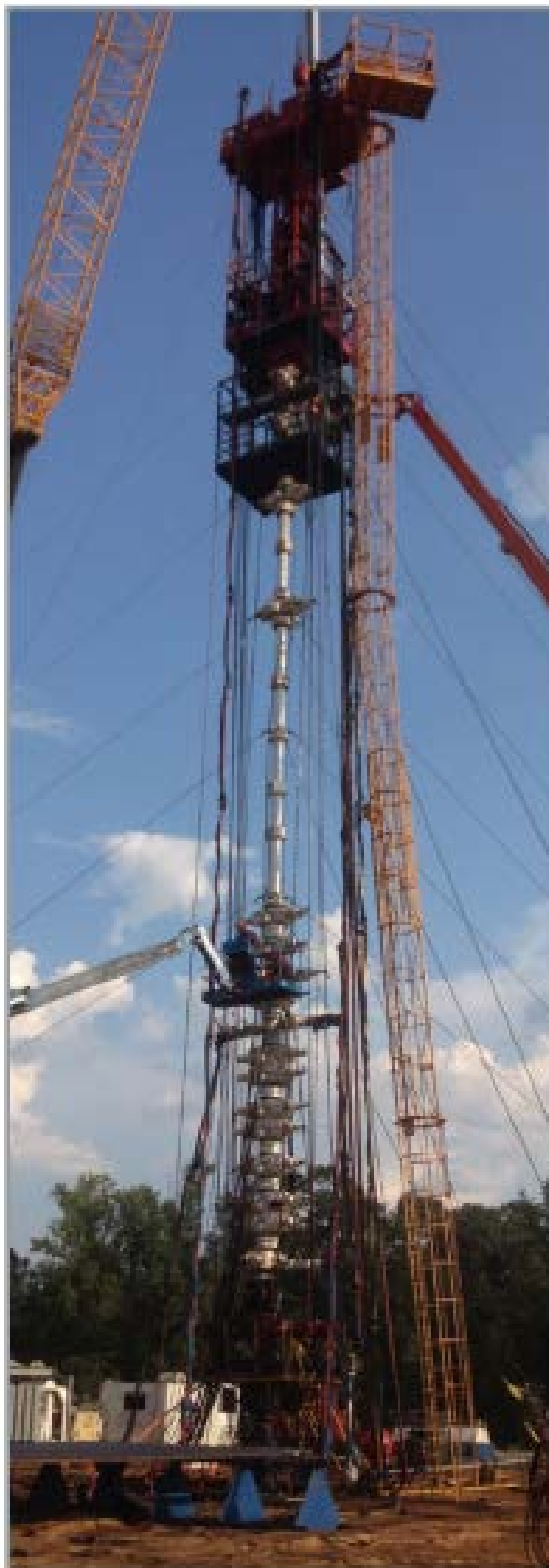
Εικόνα 6.15 : Εξέδρα μονάδας υδραυλικής συντήρησης (hydraulic workover/snubbing unit rig) της εταιρίας Halliburton. (64)
