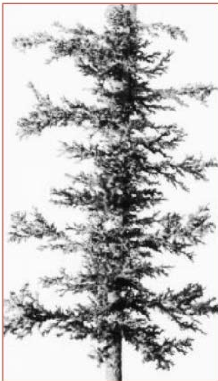
Εικόνα 8.7 : Εργαστηριακό καλούπι από κανάλια που δημιουργήθηκαν σε ασβεστολιθικό παραγωγικό σχηματισμό με την εισπίεση διαλύματος υδροχλωρικού οξέος από ένα κεντρικό μέσο (central conduit). (102)
