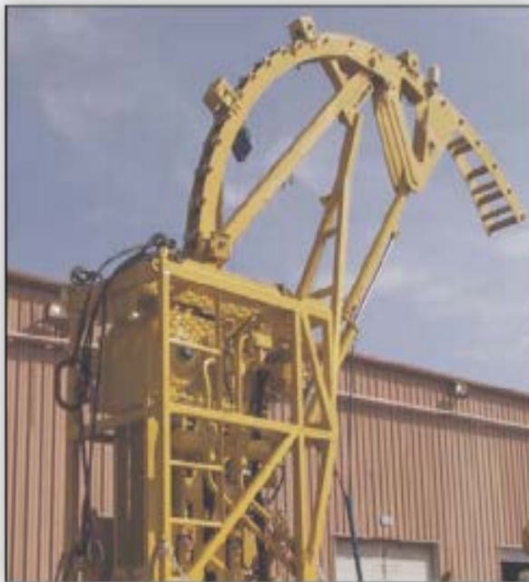
Εικόνα 3.6 : Τόξο οδήγησης εγκατεστημένο πάνω από κεφαλή προώθησης (αριστερά). (15) Εικόνα 3.7 : Τόξο οδήγησης σε θέση αναδίπλωσης (δεξιά). (16)
