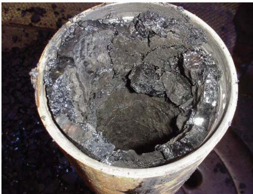
Εικόνα 7.2 : Συσσώρευση ασφαλτενίων σε σωλήνα παραγωγής. (70)
