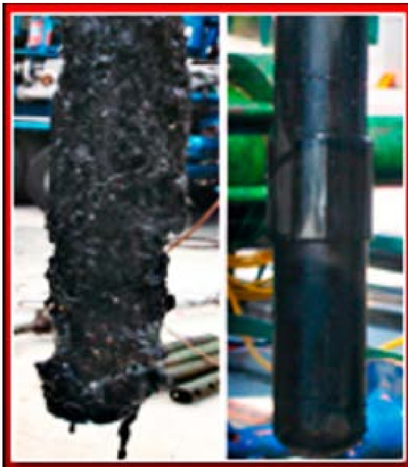
Εικόνα 7.12 : Ασφαλτένια σε τμήμα του κατώτερου εξοπλισμού στο πυθμένα, πριν (αριστερά) και μετά (δεξιά) από τη χημική απομάκρυνσή τους. (82)
