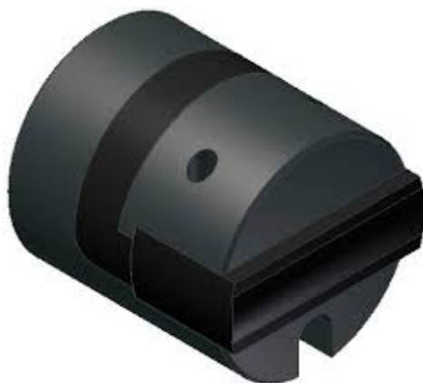
Εικόνα 3.16 : Έμβολο σφράγισης (blind ram) με ελαστομερές στοιχείο στο άκρο του. (26)
