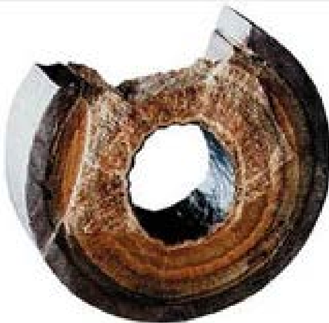
Εικόνα 7.8 : Απόθεση ανόργανων επιφανειακών επιστρωμάτων (inorganic scales) σε παραγωγική γεώτρηση πετρελαίου. (74)
