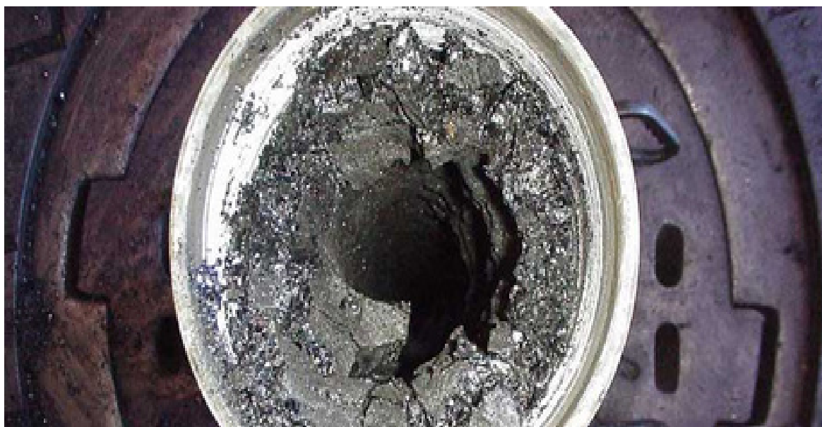
Εικόνα 7.5 : Απόθεση κηρών σε σωλήνα παραγωγής. (72)
