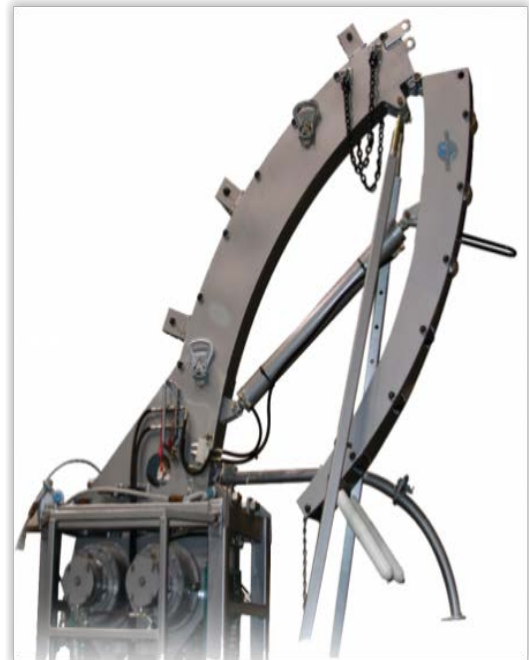
Εικόνα 3.6 : Τόξο οδήγησης εγκατεστημένο πάνω από κεφαλή προώθησης (αριστερά). (15) Εικόνα 3.7 : Τόξο οδήγησης σε θέση αναδίπλωσης (δεξιά). (16)
