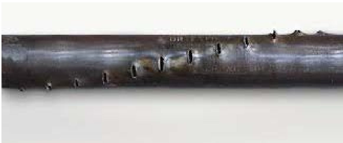
Εικόνα 6.4 : Περιστροφική διατρύπηση σωλήνωσης με τη χρήση ειδικής συσκευής (DynaSlot) με τετραγωνικά στόμια της Dyna Energetics. (52)
