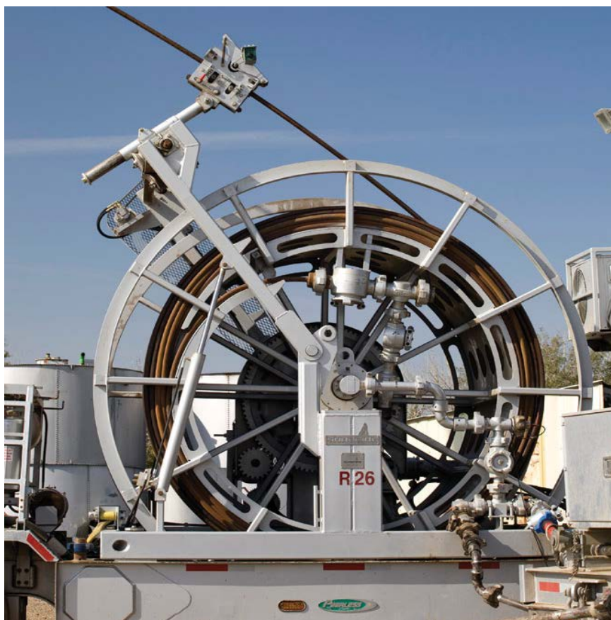
Εικόνα 3.4 : Τύμπανο περιέλιξης (Coiled Tubing Reel) (13)
