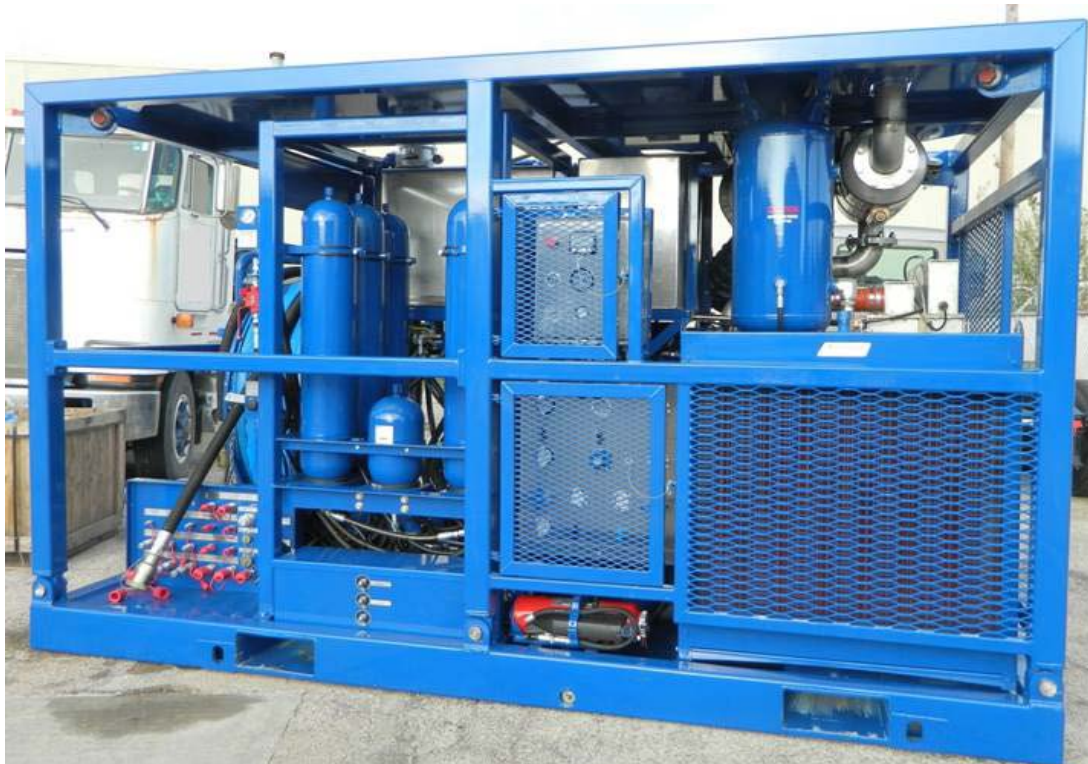
Εικόνα 3.8 : Τυπική υδραυλική μονάδα παροχής ισχύος με κινητήρα ντίζελ (hydraulic power-drive unit) (18)
