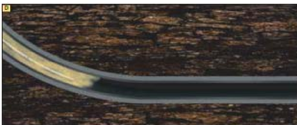
Εικόνα 7.11 : Καθαρισμός οριζόντιων γεωτρήσεων από υλικά απόθεσης (fills) με τη χρήση περιελιγμένου σωλήνα. (80)
