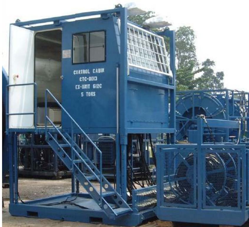
Εικόνα 3.9 : Θάλαμος ελέγχου μονάδας περιελιγμένου σωλήνα (19)
