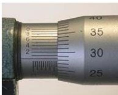
Τα μικρόμετρα χρησιμοποιούνται για τη μέτρηση εξωτερικών και εσωτερικών διαστάσεων, μέτρηση βάθους και με τη χρήση κατάλληλων επαφών για μέτρηση σπειρωμάτων, χαρακτηριστικών οδοντωτών τροχών, πάχους σωλήνων, ακόμα και για μέτρηση πολυωνυμικών καμπυλών ( splines). Ών.
