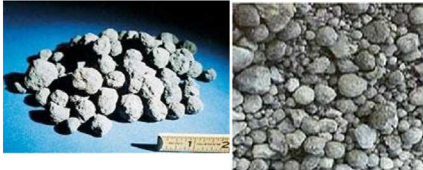
Σχήμα 7. Σφαιρίδια (pellets) μεγέθους 15-25 mm του κλίνκερ τσιμέντου (προϊόν της διεργασίας πυροσυσσωμάτωσης στην περιστροφική κάμινο)
