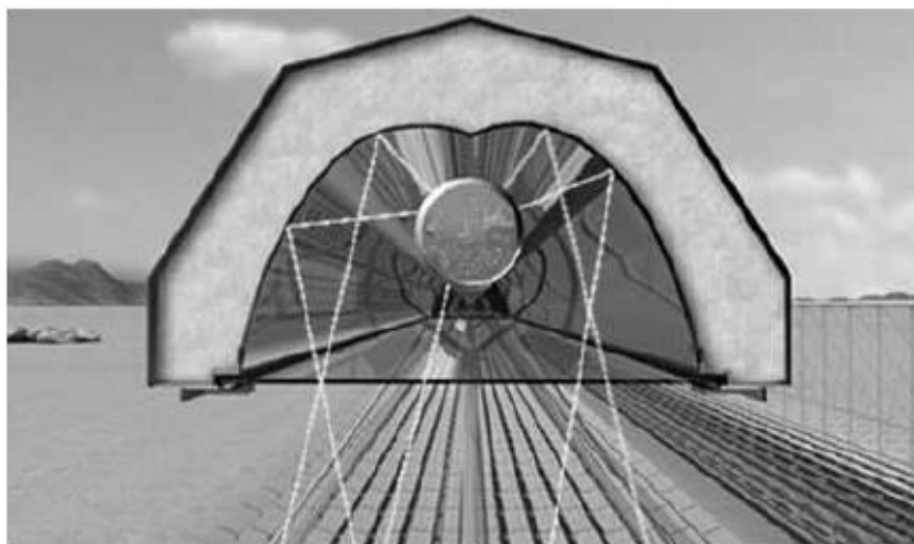
Σχήμα 2.5: Τομή δέκτη γραμμικού συλλέκτη Fresnel [7]
