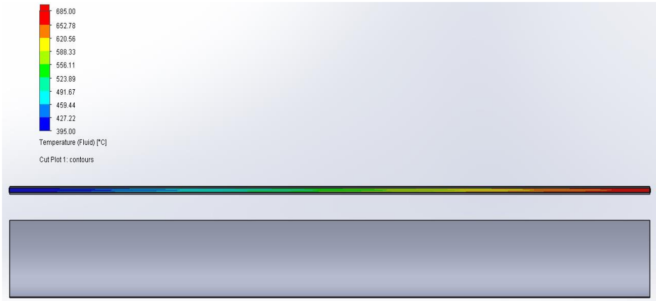
Σχήμα 5.21: Κατανομή θερμοκρασίας He στο εσωτερικό του απορροφητή (τομή στη μέση)
