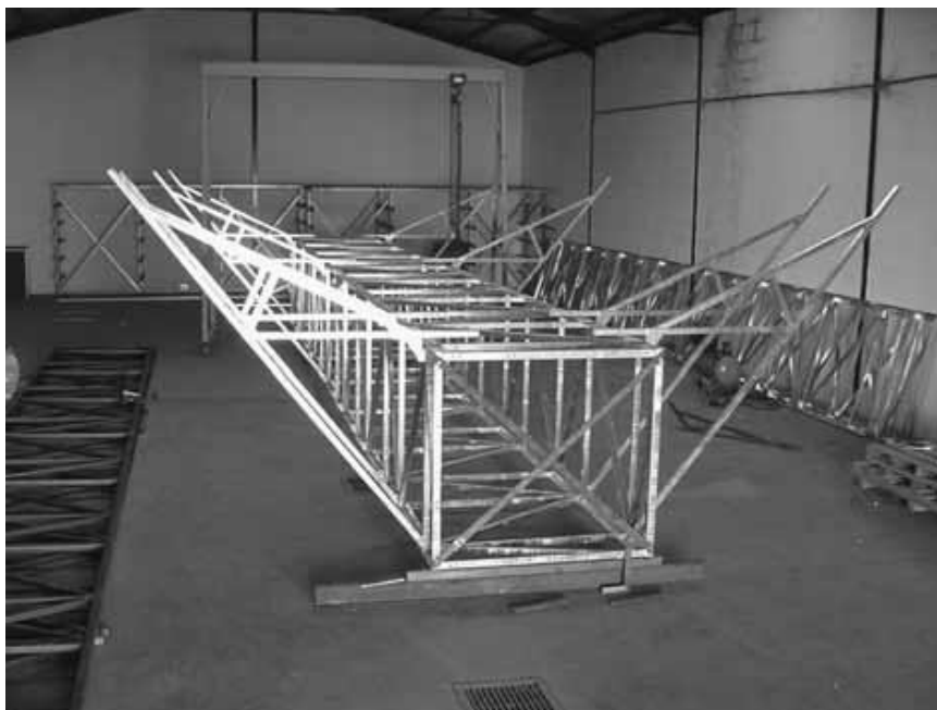
Σχήμα 2.15: Δικτύωμα στήριξης συλλέκτη ET-100 [7]
