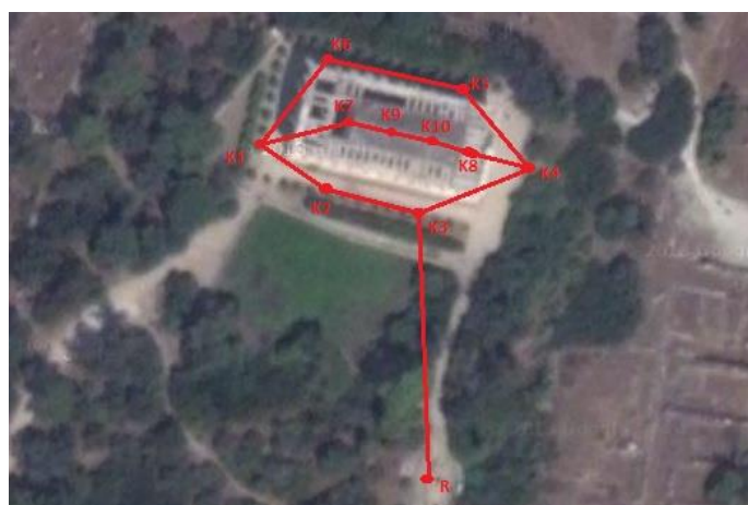
Εικόνα 29: Δίκτυο κατακόρυφου ελέγχου.
