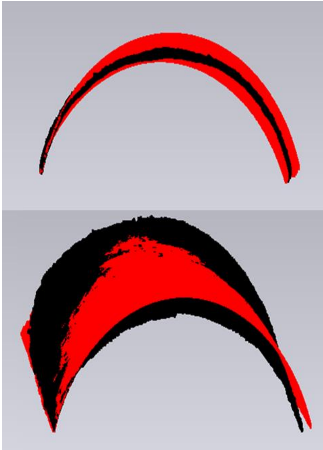
Εικόνα 39: Προσαρμογή των σημείων του θόλου σε κύλινδρο.
