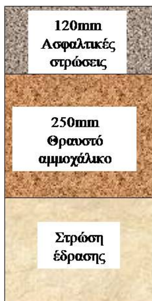
Σχήμα 10.1 Διατομή μελέτης οδοστρώματος
