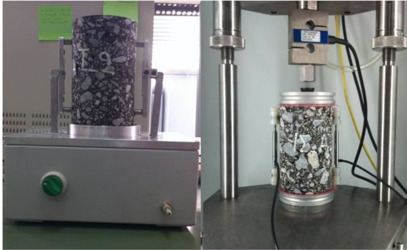
Σχήμα 5.5 Προσάρτηση μεταλλικών βάσεων στο δοκίμιο και τοποθέτηση LVDTs
