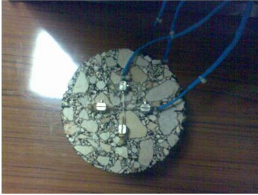
Σχήμα 2.7 Τοποθέτηση αισθητήρων LVDTs σε δοκίμιο ασφαλτομίγματος για τον προσδιορισμό του M_r με τη δοκιμή έμμεσου εφελκυσμού
