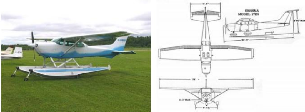
Εικόνα 3-11 Φωτογραφίες και τρισδιάστατη όψη Cessna 172 (Photo and 3-view of the Cessna 172) Πηγή: [3]
