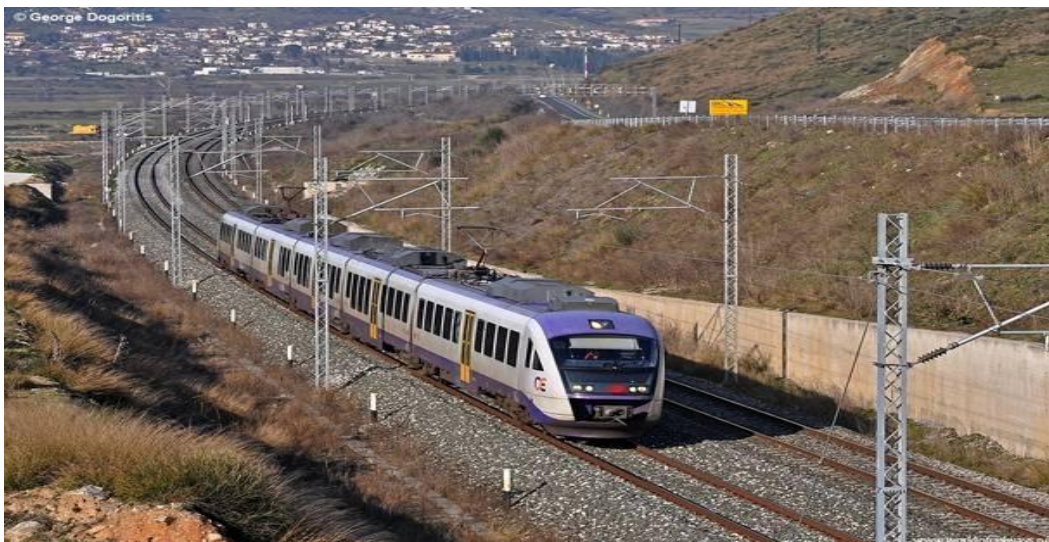
Εικόνα 14: Συρμός του προαστιακού στην Αθήνα με τον παντογράφο και τα εναέρια καλώδια τροφοδοσίας
